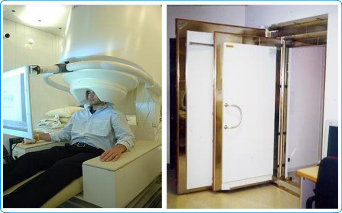
Şekil 10. MEG Ölçümü Yaptıran Hasta ve İçinde Bulunduğu Manyetik Korumalı Oda
