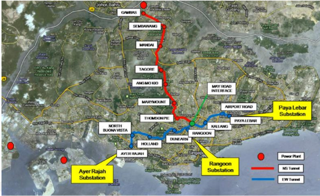
Şekil 7.4: Singapur Awards 35 km Kablo Tüneli Projesi alanı.
