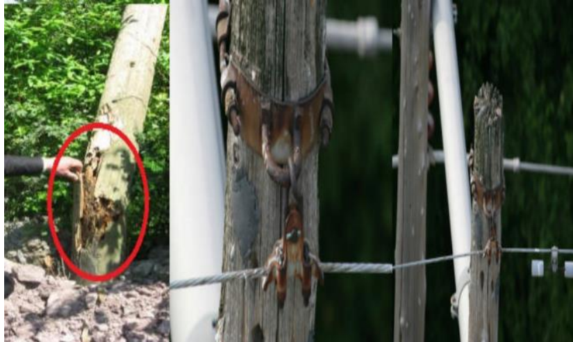
Şekil 2.5: Zamanla mukavemetini yitirerek kırılan ağaç kablo direği.
