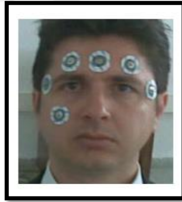
Şekil 2.5 : Elektrotların Kullanıcının Göz Çevresine Yerleştirilmesi
