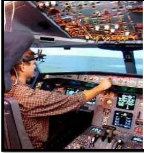
Şekil 3.7: Uçuş Eğitim Simülatoründe Bulunan Bir Göz İzleme Sistemi
