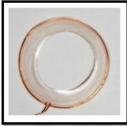
Şekil 2.6 : Manyetik Arama Bobin Kontak Lens
