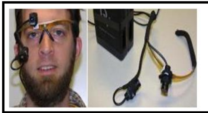
Şekil 2.12 : Göz bebeği ve Limbus İzlemek İçin Geliştirilen kafaya Monte Gözlük Tasarımı [60]
