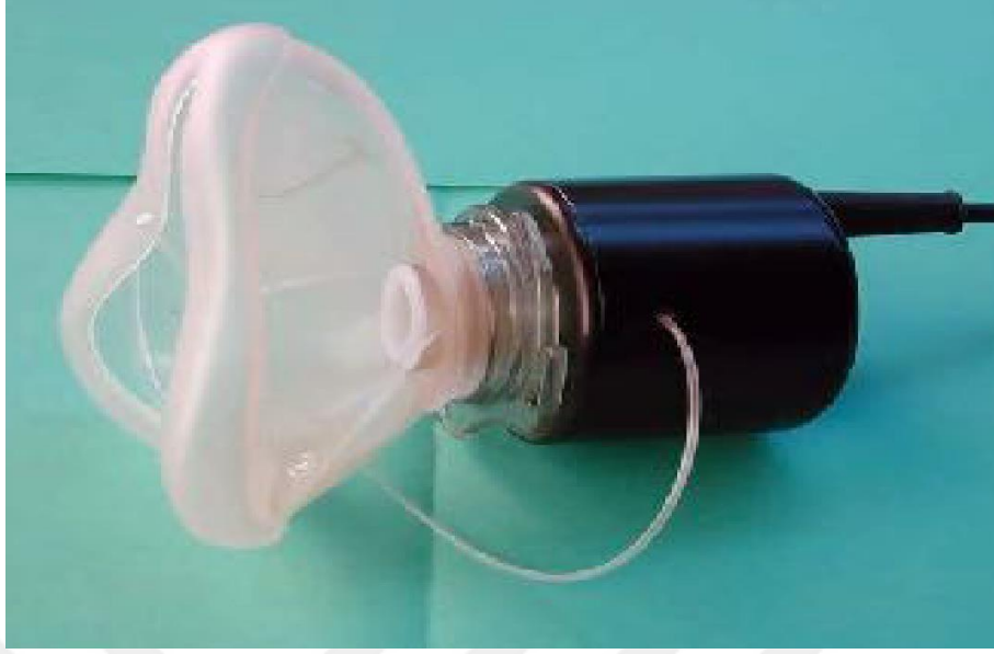
Şekil 2.6. Maske ve maskeden çıkan basınç probu görülmekte.
