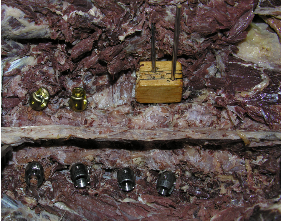
Şekil-24: 15 derece hata oluşturmak için blok yardımı ile klavuz telin yerleştirilmiş görünümü
