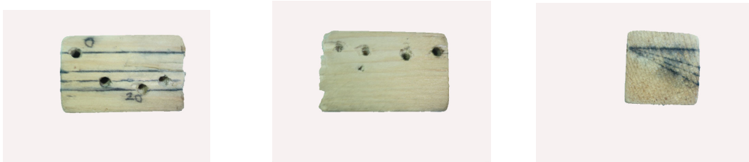
Şekil-16: 2. Blok, 0, 15, 20 derecelik tüneller
