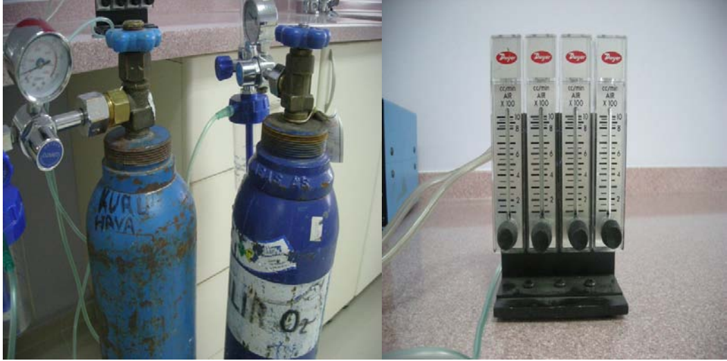
Resim 14: Oksijen-Kuru Hava Tüpleri ve Mikser
