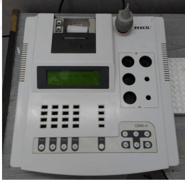
Resim 12. Veteriner Fakültesi İç Hastalıkları A.B.D' da mevcut Beijing Precil 4 kanallı yarı otomatik koagülometre cihazı
