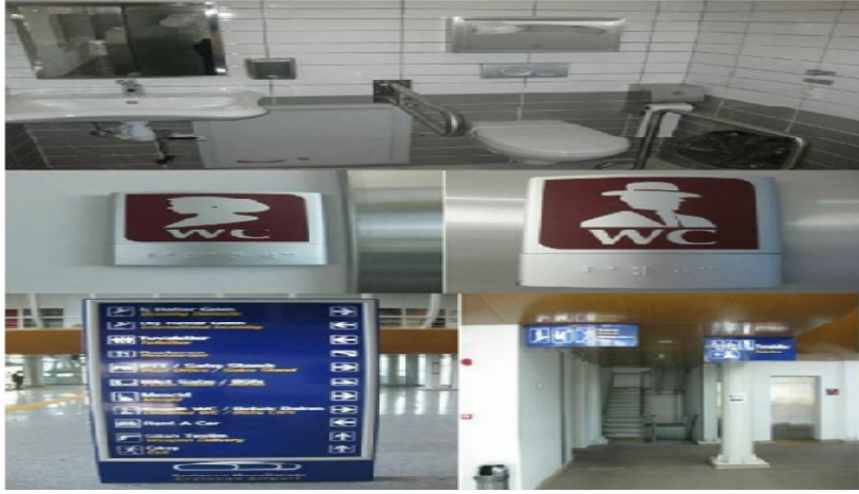
Resim 1.15: Engelli WC, WC'lerin yönlendirme levhaları ve Braille Alfabeti ile tuvalet kapılarındaki isimlik
