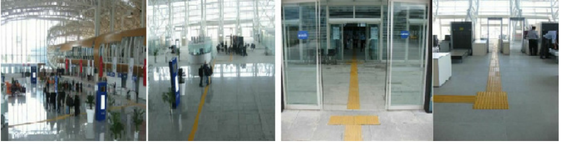
Resim 1.8: Engelli yolcuların danışma ve check-in işlemlerine ulaşabilmelerini sağlayan hissedilebilir yüzey uygulaması
