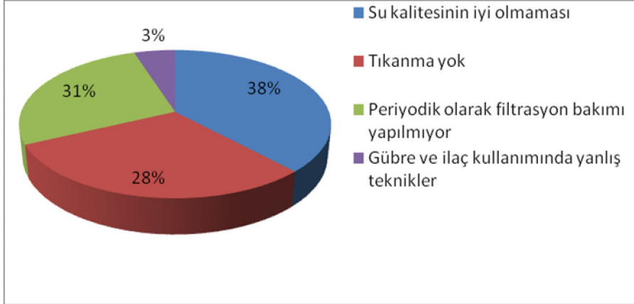
Şekil 4.11. Damla sulama sisteminde tıkanmaya neden olan sorunlar
