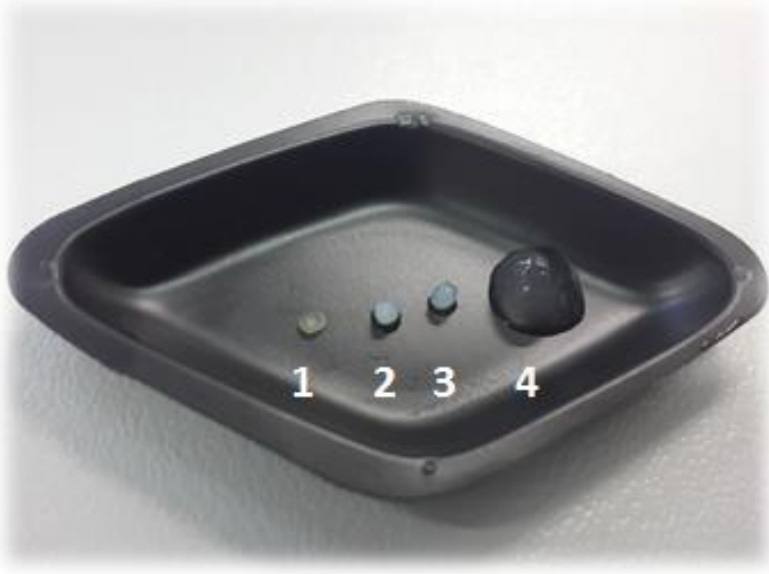
Şekil 4.15. Şişme analizi yapılan mikrokürelerin 3 saat sonunda görüntüleri (1: Kuru mikroküre; 2: Saf su ortamında şişen mikroküre; 3: Mide ortamında şişen mikroküre; 4: İnce bağırsak ortamında şişen mikroküre).
