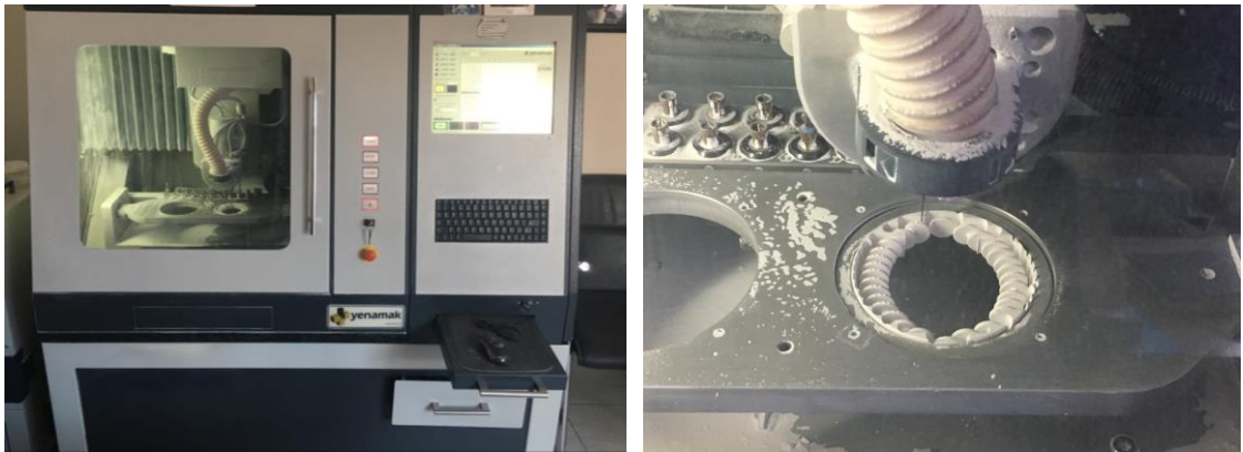
Resim 3. Disklerin frezeleme ile şekillendirilmesi
