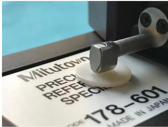
Resim 11. Profilometre cihazı ile yüzey pürüzlülüğü ölçümü
