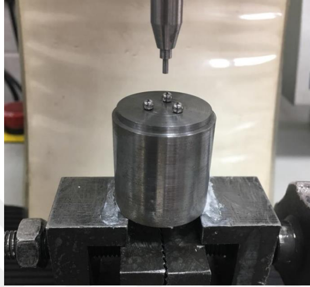
Resim 13. Biaksiyal eğme testi düzeneği
