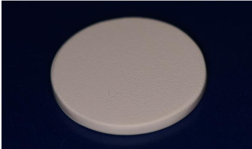
Resim 8. Sinterleme işleminden önce 20 saniye kumlanan örneğin yüzey görüntüsü
