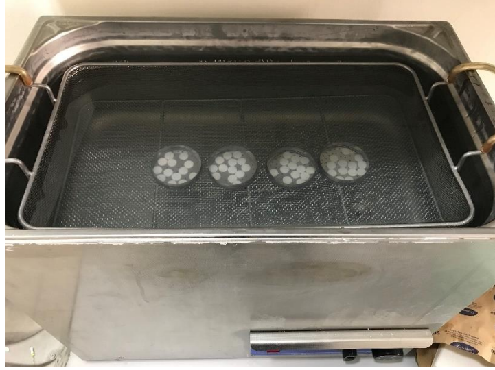
Resim 5. Örneklerin ultrasonik temizleyiciye yerleştirilmesi
