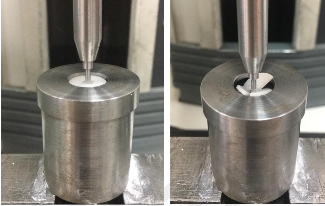
Resim 14. Örneğin kırma cihazına yerleştirilmesi ve örneğin kırılması
