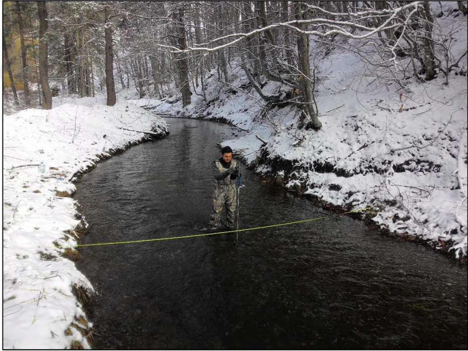
Şekil 3.3. Akarsu Q – V – D – W Ölçümleri (Abant Çayı Başlangıç Noktası)
