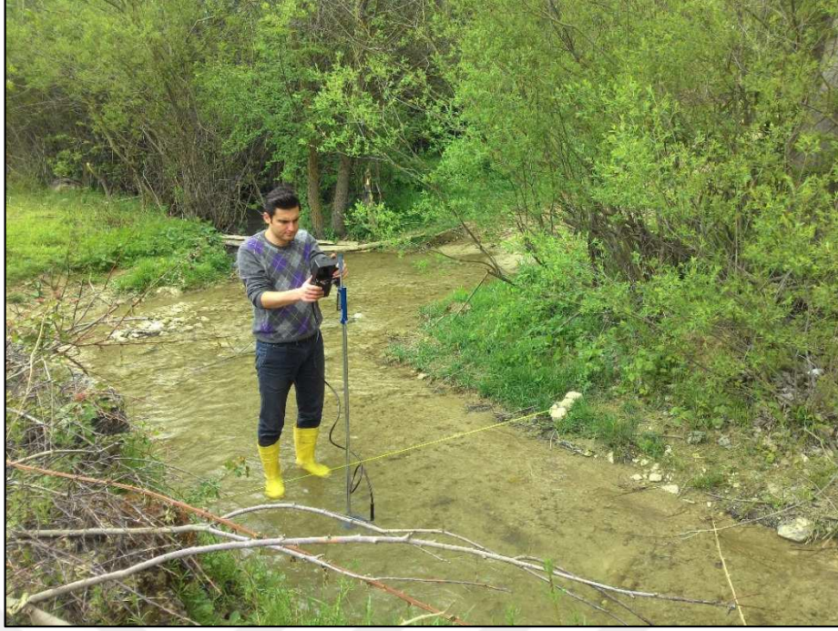
Şekil 3.4. Akarsu Q – V – D – W Ölçümleri (Mudurnu Çayı Başlangıç Noktası)
