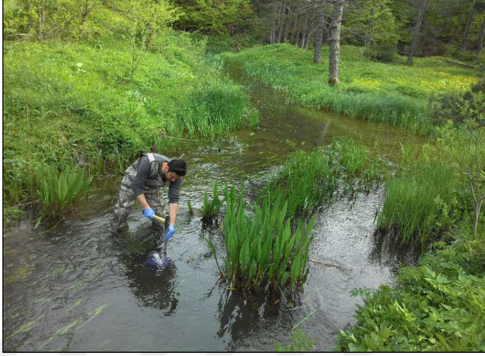
Şekil 3.2. ÇO – T_{su} Ölçüm Cihazlarının Akarsu Yatağına Yerleştirilmesi
