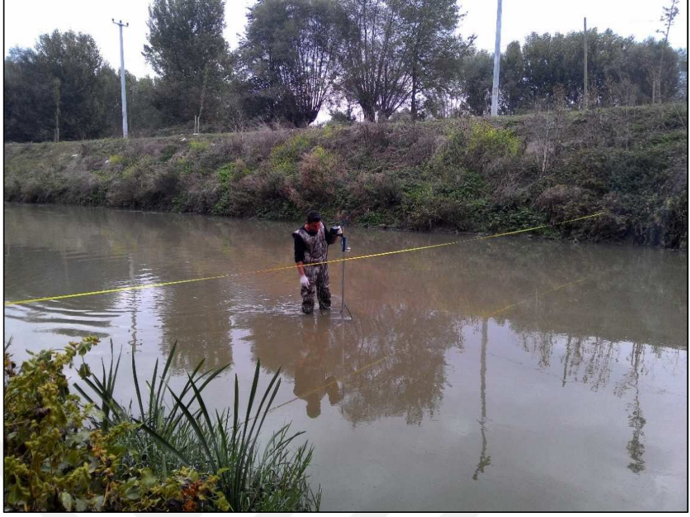
Şekil 3.6. Akarsu Q – V – D – W Ölçümleri (Deşarj Sonrası, Büyüksu Deresi)
