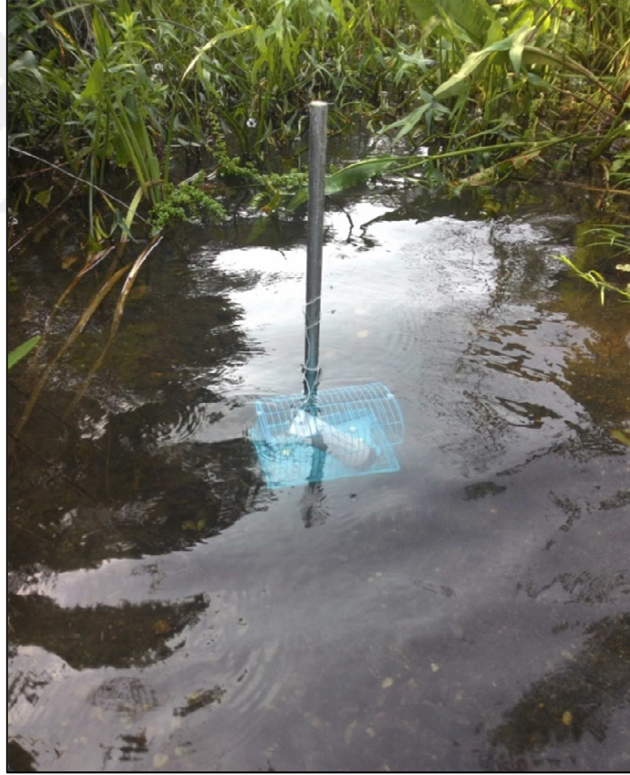
Şekil 3.1. Koruma kafesi ve galvanize kazık.
