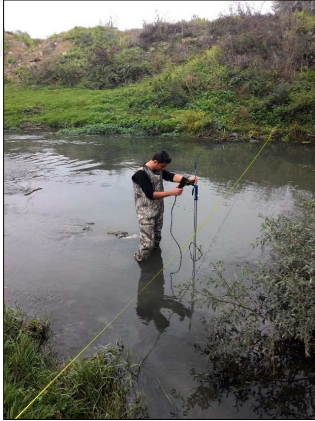
Şekil 3.5. Akarsu Q – V – D – W Ölçümleri (Deşarj Öncesi, Büyüksu Deresi)
