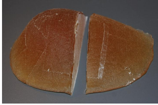
Şekil 2.13 Transvers kesitin iç kısmı bantla kaplanmış meme şeklinde fantom.
