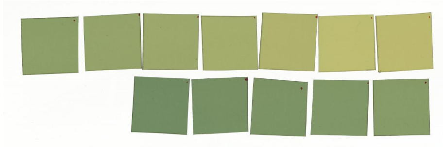
Şekil 2.23 Kalibrasyon için farklı dozlarda ışınlanan filmler.
