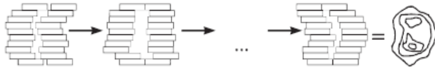
Şekil 2.2: Step and Shoot MLC tekniğine göre doz dağılımı
