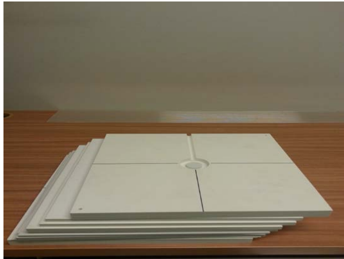
Şekil 3.5 PTW Slab RW3 Fantom
