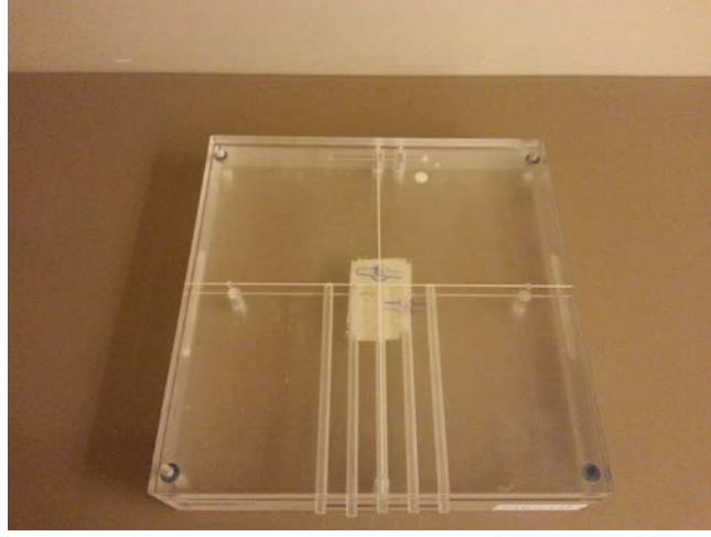
Şekil 3.4 PTW Universal Yoğunluk Ayarlı Radyoterapi Doğrulama Doğrulama Fantomu
