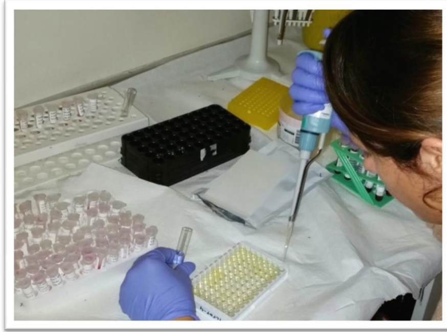
Resim-3. ELISA yönteminde stop solüsyonu konulduktan sonraki sarı renk oluşumu (IGFBP-4 düzeylerinin ölçümü sırasında)
