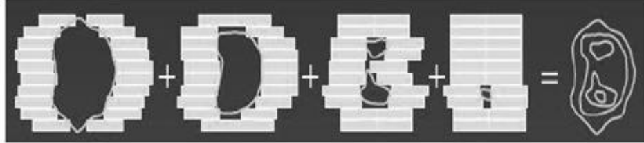
Şekil 2.5: Step and Shoot IMRT tekniğinin şematik gösterimi
