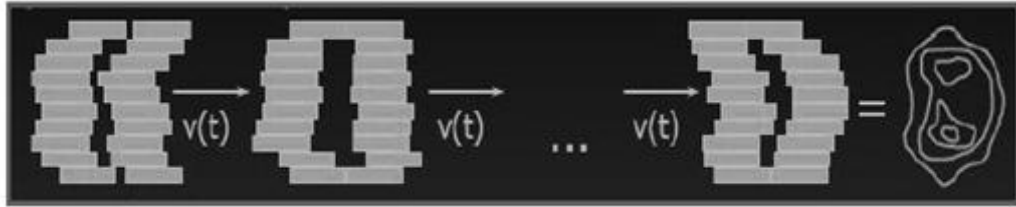
Şekil 2.9: Dinamik MLC tekniğinin şematik gösterimi
