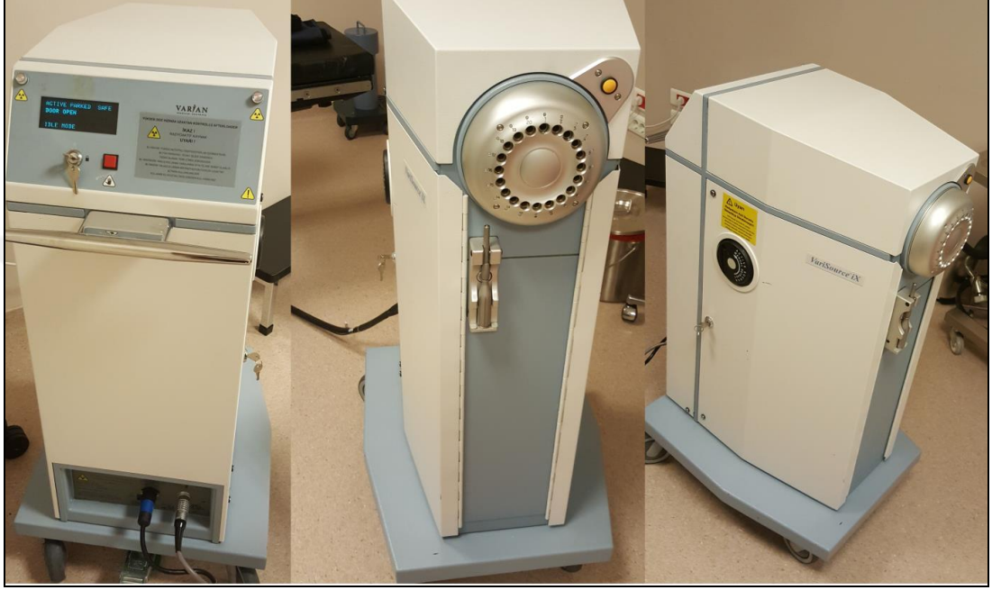
Şekil 3-1.VariSource™ IX (Varian) sonradan yüklemeli brakiterapi cihazı
