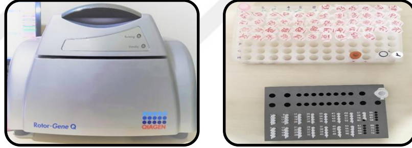
FOTOĞRAF 3.3. PZR CİHAZI VE PZR TESTİ İÇİN HAZIRLANAN KARIŞIM
