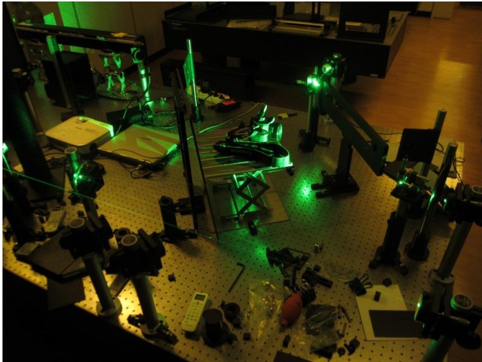
112. Geçirgen hologram-H1 kayıt masası - Pozlama hazırlığı (fotoğraf: Vildan Işık)
