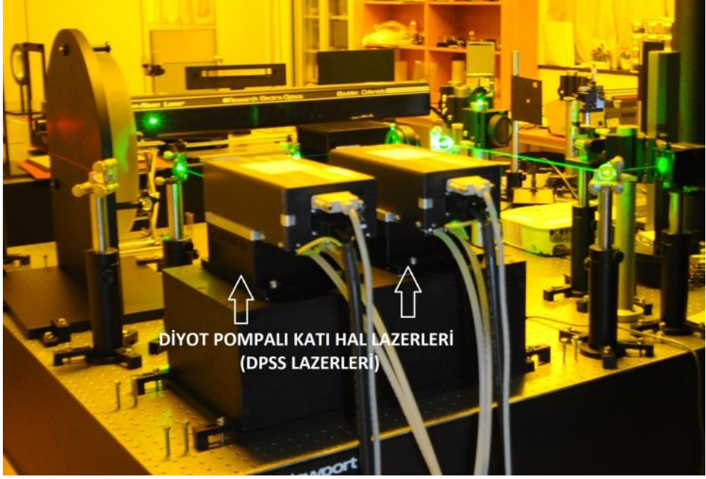
31. Yeşil ve mavi ışın veren diyot pompalı katı hal lazerleri (fotoğraf: Vildan Işık-a)
