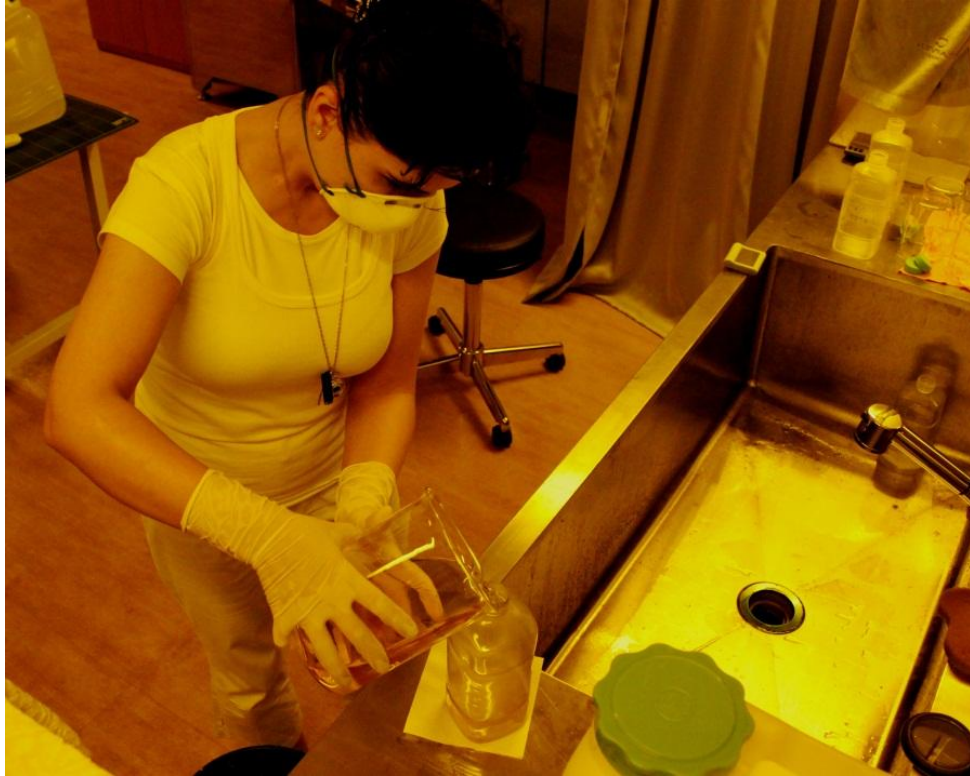
120. Banyo işleminde kullanılan solüsyonların hazırlanması CW-C2 banyosu için Solüsyon A ve Solüsyon B birebir oranında karıştırılmaktadır, Vildan Işık
