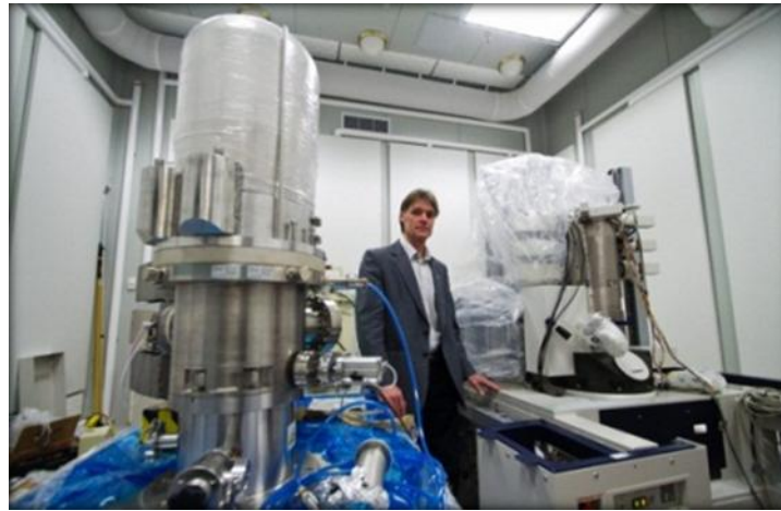
72. Victoria Üniversitesi tarafından geliştirilen dünyanın en büyük atomaltı elektron holografi mikroskobu
