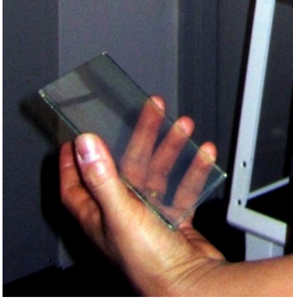
39. Banyosu yapılmış gümüş halide emülsiyonla kaplı bir holografik cam plaka (fotoğraf: Vildan Işık-a)
