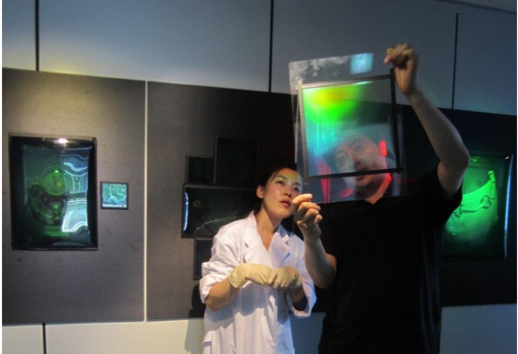
38. Kolay görüntülemek için cam üzerine bantlanan gümüş halide emülsiyonlu holografik filmin sonuç görüntüsünün incelenmesi, holografi sanatçısı Kyung Lee ve fizik mühendisi Kwang Ho Ok (fotoğraf: Vildan Işık-a)
