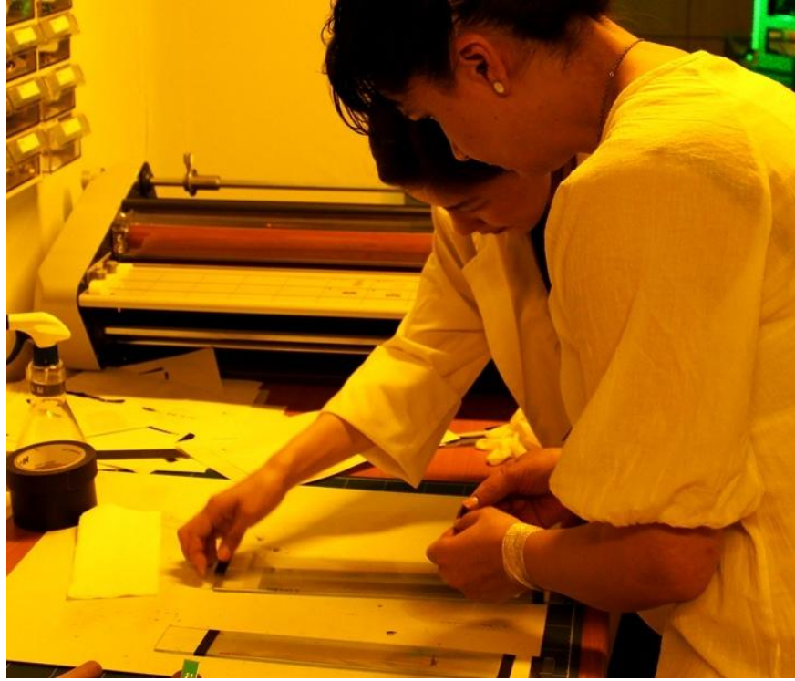
126. Daha önce yapılan geçirgen hologram-H1'lerin, H2 kaydı için hazırlanması, Vildan Işık ve Kyung Lee. Banyosu yapılmış H1 filmler, H2 kaydı için cam üzerine bantlanarak hazırlanmaktadır.
