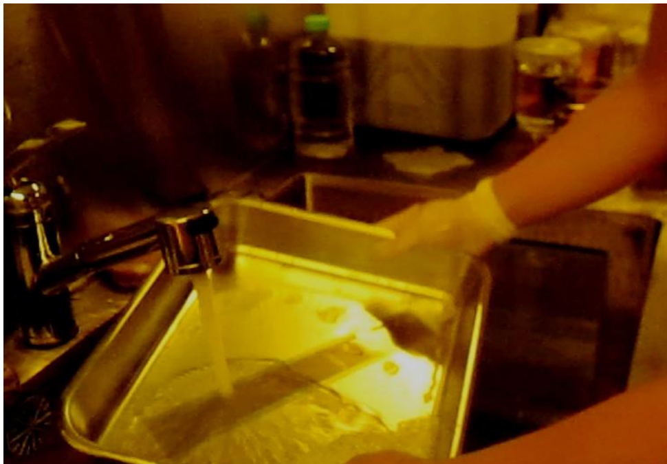
121. Ağartma - Durulama Geçirgen hologram-H1'e uygulanan ağartmanın ardından su ile yapılan durulama işlemi (fotoğraf: Vildan Işık)
