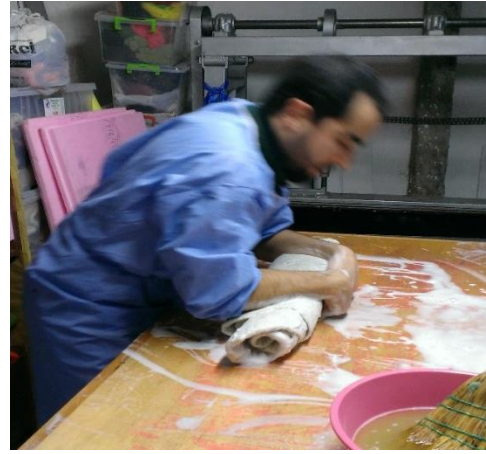
Resim 5.65. Islatılan yarı keçeler el ve kol yardımıyla pişirilmesi (Özgün 2015)
