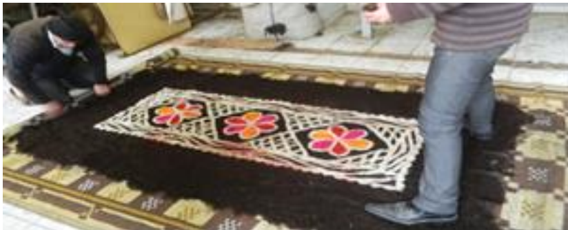
Resim 4.23. Ham keçenin çekilerek kırıksıklıklarının giderilmesi (Özgün 2015)
