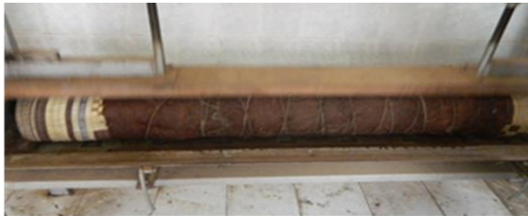
Resim 4.20. Hazırlanan rulonun tepme makinesine yerleştirilmesi (Özgün 2015)
