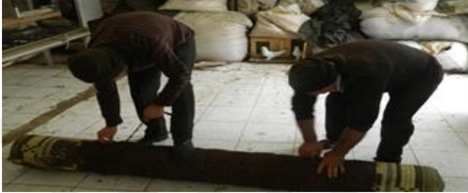
Resim 4.19. Hazırlanan rulonun halat yardımıyla bağlanması ve düğüm atılması (Özgün 2015)
