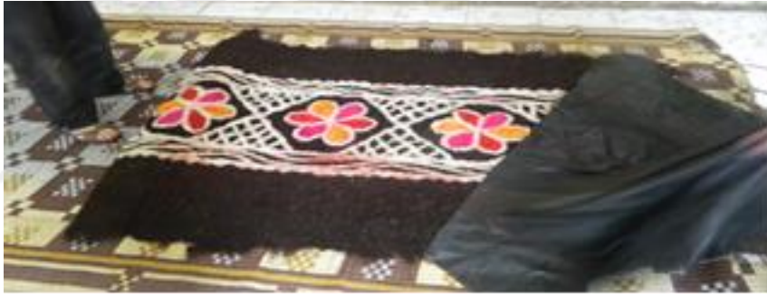
Resim 4.22. İlk tepme işlemi sonrası ham keçenin bezden ayrılması (Özgün 2015)
