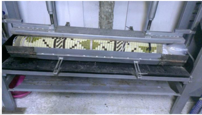
Resim 5.63. Sarılan yünlerin tepme makinesinde tepilmesi (özgün 2015)
