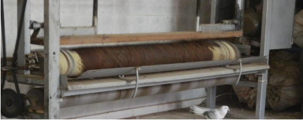
Resim 2. 6. Keçe tepme makinesi-dövme makinesi (Özgün 2015)
