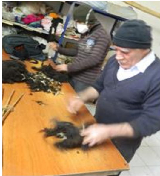
Resim 4.1. Yünlerin içerisinde yabancı maddelerin seçilmesi ve renklerine göre ayrılması (Özgün 2015)
