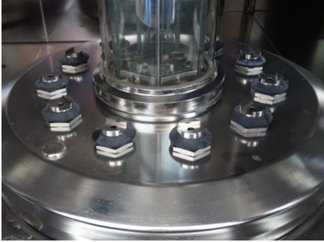
Resim 4.12. Işık haslıđı cihazı numuneleri yerleřtirme aparatları
