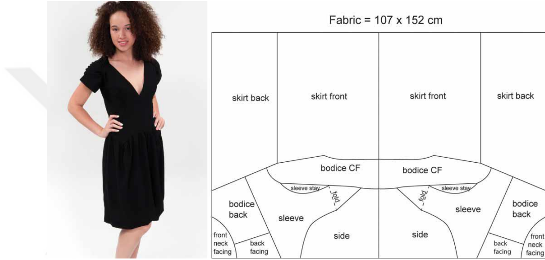
Resim 2.9. Puzzle yöntemiyle kesilmiş küçük siyah elbise ve kalıbı (Carrico ve Kim, 2014, s.60)
