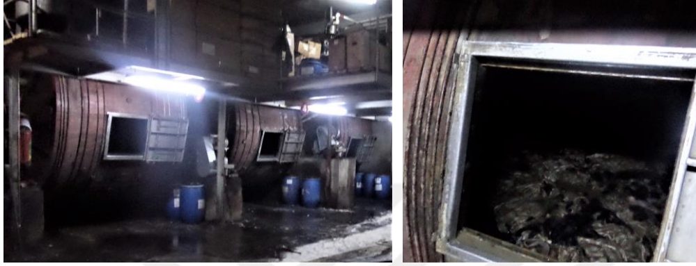
Resim 4.38. Yumuşatma işleminin yapıldığı deri işleme dolapları ve detayı Gerede Deri OSB, Tabakhaneler (Çınar, 2015)
