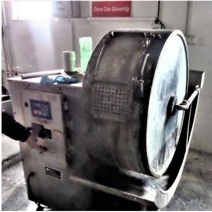
Resim 4.53c. Küçük çaplı tabaklama dolabı AİBÜ Gerede MYO (Çınar, 2015)
