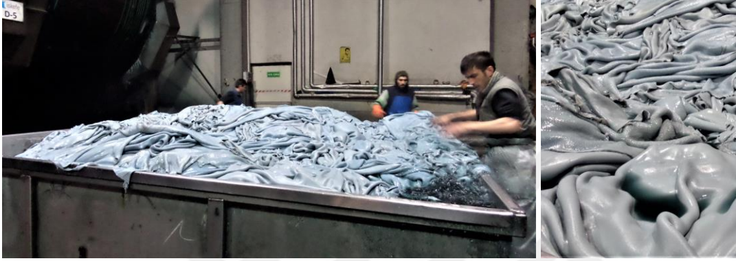
Resim 4.52. Krom ile derilerin işlenmesi ve kromlu deri detay, Gerede Deri OSB Tabakhaneler (Çınar, 2015)
