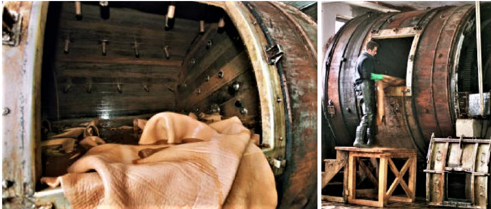
Resim 4.60. Boyama dolabının iç kısmı ve dolabın genel görünüşü AİBÜ Gerede MYO (Çınar, 2015)
