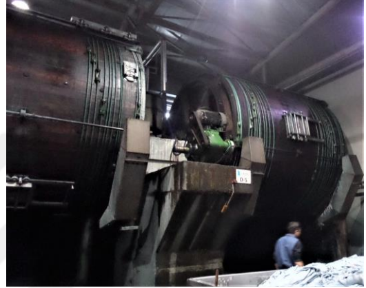
Resim 4.53b. Tabaklama dolabı, Gerede Deri Tabakhaneler (Çınar, 2015)
