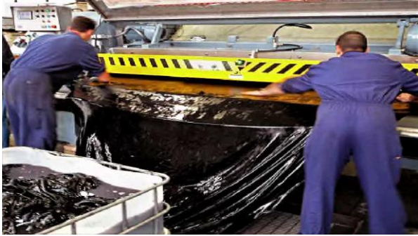
Resim 4.61. Sıkma makinesine boyalı (yaş) derinin verilmesi (Dikmelik, 2013, s. 285)
