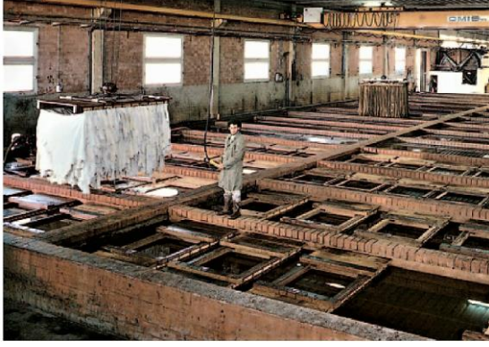
Resim 4.47. Kösele fabrikasındaki havuz sistemi AİBÜ Gerede MYO (Soluk, 2015)
