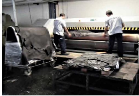
Resim 4.62. Boyanmış derinin açılma işlemi (Dikmelik, 2013, s. 285)
