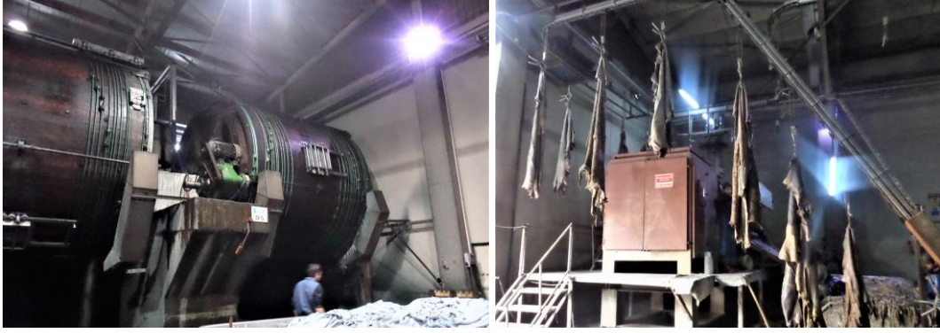
Resim 4.49. Derilerin dolaba aktarılışı, Gerede Deri OSB, Tabakhaneler (Çınar, 2015)
