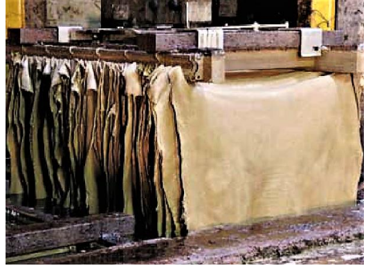
Resim 4.48. Derilerin havuzlara çerçeveler yardımıyla daldırılması, AİBÜ Gerede MYO (Soluk, 2015)
