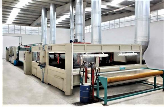
Resim 4.68. Sprey (Pistole) finisaj makinesi (Dikmelik, 2013, s. 343)
