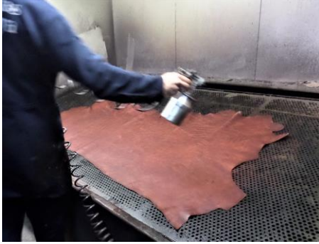
Resim 4.58. Elde yapılan yüzey boyama Gerede Deri OSB Tabakhaneler (Çınar, 2015)
