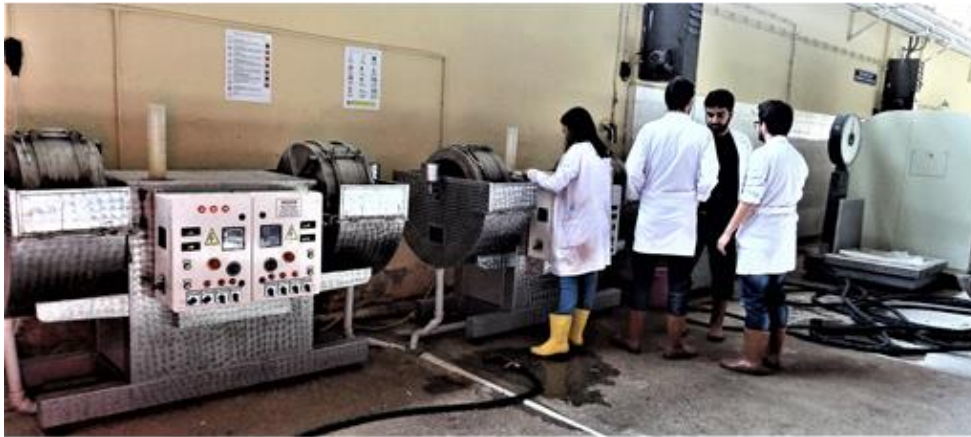
Resim 4.37. Yumuşatma İşleminin yapıldığı pervaneli tekneler, EÜ Mühendislik Fakültesi Deri Mühendisliği Bölümü, Araştırma ve Uygulama İşletmesi (Çınar, 2015)
