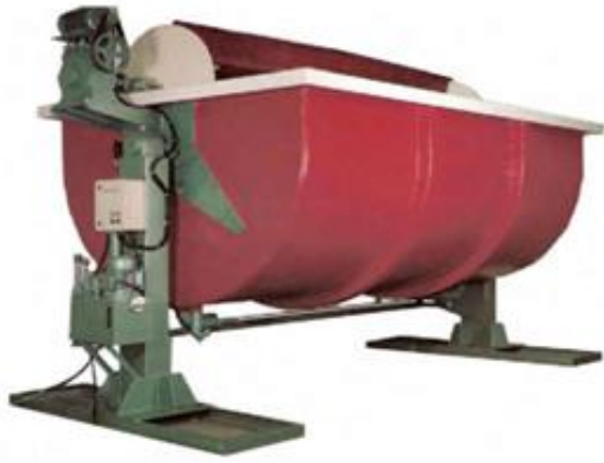
Resim 4.36. Yumuşatma işleminin yapıldığı pervaneli tekne (Dikmelik, 2013, s. 17)
