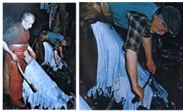
Resim 4.42. Kavaleta tahtası üzerinde yapılan etleme işlemi (Dağtaş, 2007c, s. 18)
