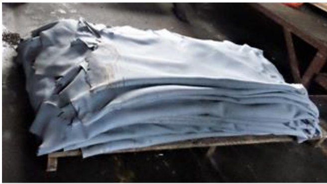
Resim 4.50. Krom ile tabaklanan deriler, Gerede Deri OSB Tabakhaneler (Çımar, 2015)
