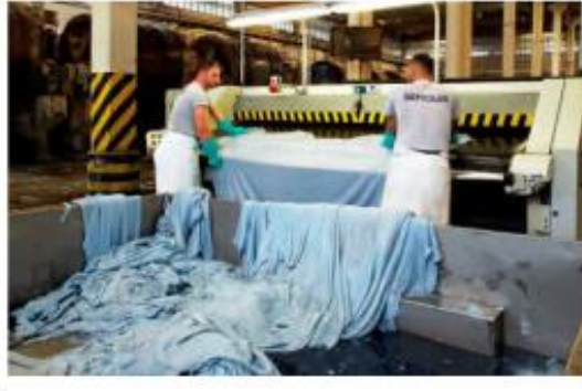
Resim 4.55. Derilerin sıkma makinesinden geçirilmesi (Dikmelik, 2013, s. 187)
