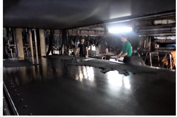
Resim 4.66b. Vakum makinesine derilerin yayılması Gerde Deri OSB, Tabakhaneler (Çınar, 2015)
