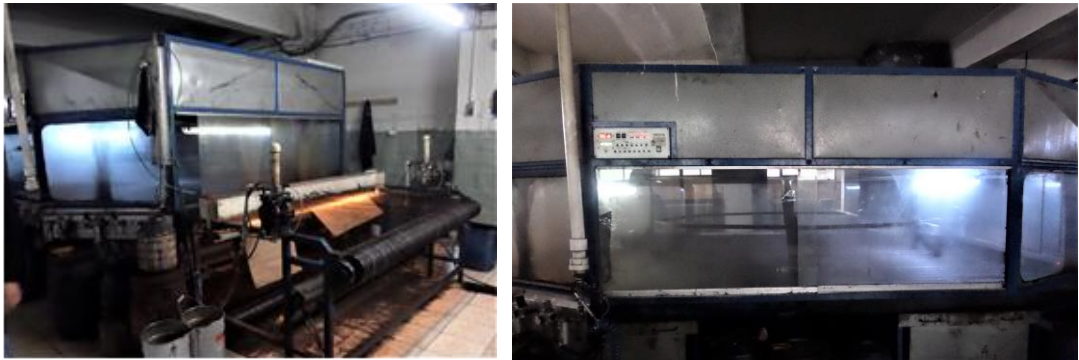
Resim 4.57. Makinede yapılan yüzey boyama, Gerde Deri OSB, Tabakhaneler (Çınar, 2015)
