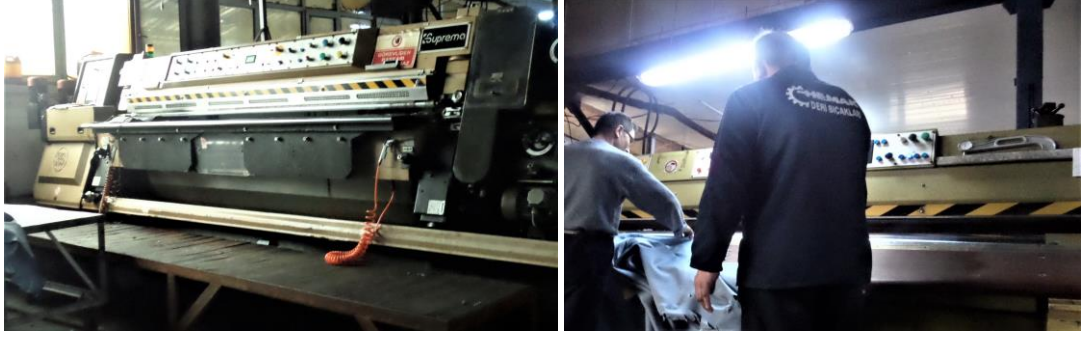
Resim 4.45. Yarma makinesi ve yarma işleminin pratikte görünüşü Gerede Deri OSB, Tabakhaneler (Çınar, 2015)
