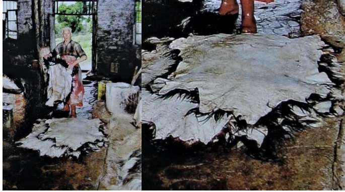
Resim 4.6. Derilerin tuzlanması ve detayı EÜ Deri Mühendisliği Bölümü (Çınar, 2015)
