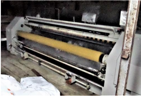
Resim 4.43. Kıl kazıma- Etleme makinesi Gerede Deri OSB, Tabakhaneler (Çınar, 2015)
