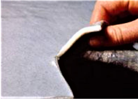
Resim 4.46. Kireci giderilmiş ve sama yapılmış deri AİBÜ Gerede OSB (Soluk, 2015)
