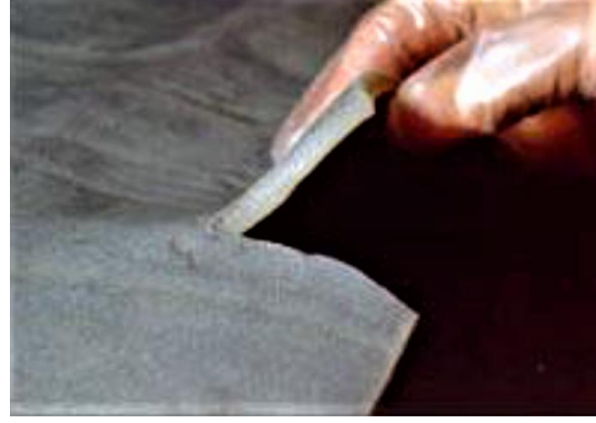
Resim 4.40. Kireçlik işlemi yapılmış deri, AİBÜ Gerede MYO (Soluk, 2015)
