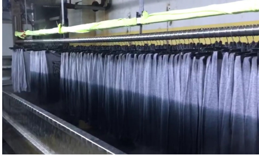
Resim 4.12. Degrade boyama makinesi ile seri boyama ( fot. E. Obut-2017)
