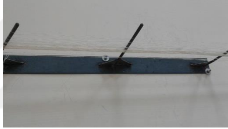
Resim 4. 62. Alt-üst çapraz yapılarak çözgü ipliğinin çekilmesi
