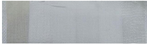
Resim 2. 14. Yıkamada kullanılan multifiber bez (Öztürk, 2017)
