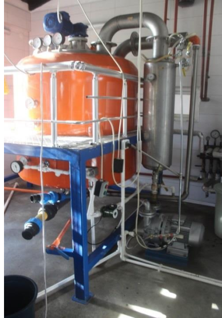
Resim 4. 6. Yoğunlaştırma makinesi (Öztürk, 2016)
