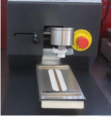
Resim 2. 18. Sürtme haslık cihazı (Öztürk, 2017)
