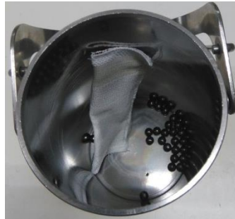
Resim 2. 16. İpliğin ve bilyelerin yıkama tüpüne konulması (Öztürk, 2017)
