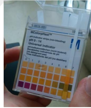
Resim 4. 25. pH değerinin ölçülmesi (Öztürk, 2016)
