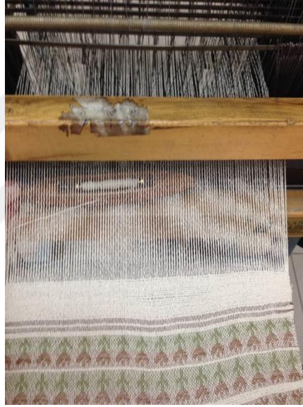
Resim 4. 74. Mekiğin ağzlığın arasından atılması
