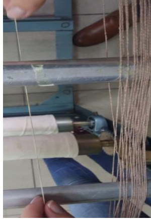
Resim 4. 63. İpliklerin Gücü Tellerine Aktarılması
