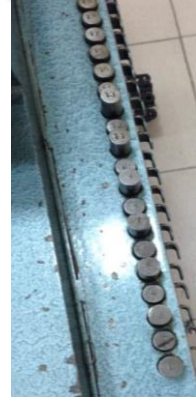
Resim 4. 70. Armür raporuna göre basılan tuşlar
