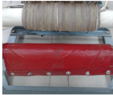
Resim 4. 67. İpliklerin çözgü levendine sarılması
