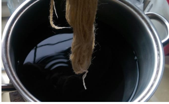
Resim 4. 27. İpliğin boyarmadde çözeltisi içine konulması (Öztürk, 2016)
