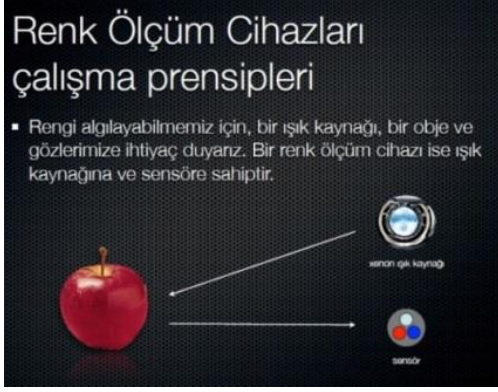
Resim 2.35. Renk ölçüm cihazı çalışma prensibi (URL 6)
