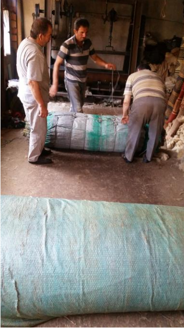
Resim 2. 42. Sarılan hasırın halat ile sıkıca bağlanması (Erkuş Atölye - Afyonkarahisar, 2018).
