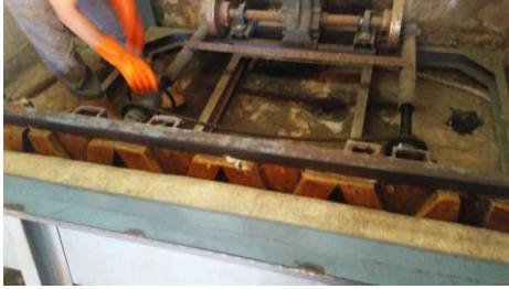
Resim 2. 46. Sulanan ve sabunlanan keçenin pişirilmesi (Erkuş Atölye - Afyonkarahisar, 2018).
