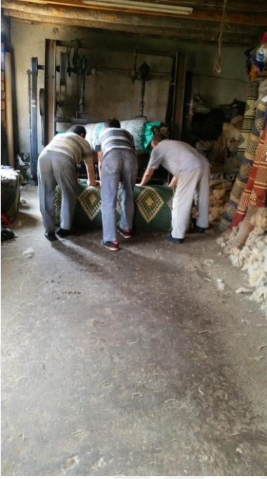
Resim 2. 41. Sarıldıktan sonra birkaç kez yuvarlanması (Erkuş Atölye - Afyonkarahisar, 2018).
