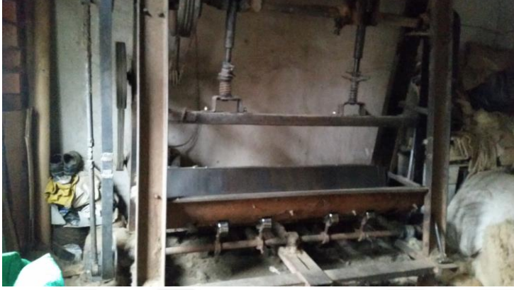
Resim 2. 29. Tepme makinesi (Dövme makinesi) (Erkuş Atölye - Afyonkarahisar, 2018).
