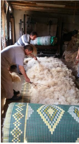
Resim 2. 39. Hasır üzerine yünün atılması (Erkuş Atölye - Afyonkarahisar, 2018).
