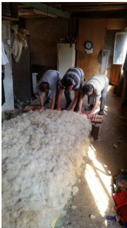
Resim 2. 40. Yünün hasırla birlikte sarılması (Erkuş Atölye - Afyonkarahisar, 2018).
