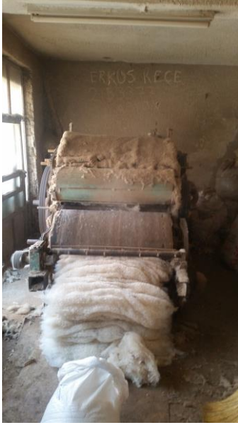
Resim 2. 28. Tarak (hallaç) makinesi (Erkuş Atölye - Afyonkarahisar, 2018).
