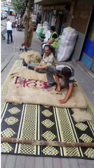
Resim 2. 44. Keçeleşen yünün açılıp kenarlarının düzenlenmesi ve tekrar tepme makinesinde tepilmesi (Erkuş Atölye - Afyonkarahisar, 2018).
