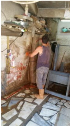
Resim 2. 47. İşlem sonrası keçenin yıkanıp, arınması (Erkuş Atölye - Afyonkarahisar, 2018).
