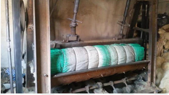
Resim 2. 43. Hasıra sarılan yünün tepme makinesinde dövülmesi (Erkuş Atölye - Afyonkarahisar, 2018).
