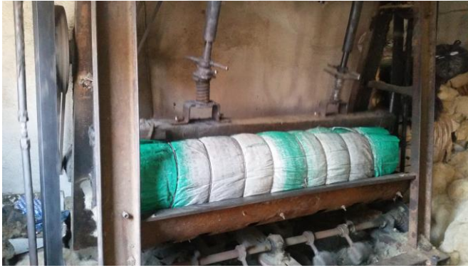
Resim 2. 30. Tepme makinesi (Dövme makinesi) (Erkuş Atölye - Afyonkarahisar, 2018).
