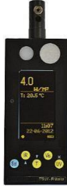
Resim 6.3. Aydınlık düzeyi, kızılötesi ve morötesi ışınım ölçen cihaz (URL-37)
