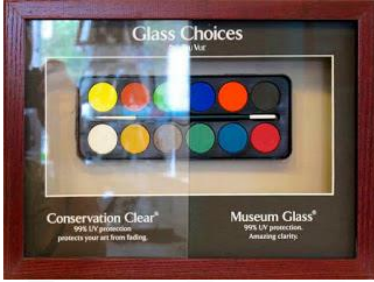
Resim 5.2. Müzelerde kullanılan iki farklı UV koruma sağlayan camlama malzemesi (URL-30)
