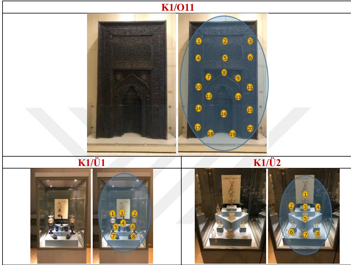
Çizelge 7.11. (devam) Aydınlık düzeyi ölçümü için seçilen objeler/ üniteler ve ölçüm alınan noktalar ( K: Katalog, O: Objeler, Ü: Ünite, Rakamlar: Seçilen obje/ ünite numaraları)
