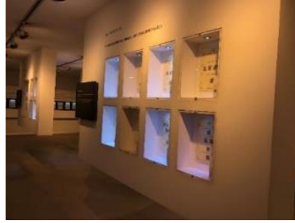
Resim 8.14. Üniteler içerisinde kullanılan farklı LED lambaların neden olduğu farklı renk izlenimleri (2018)
