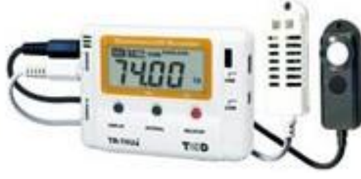
Resim 6.5. Aydınılık, UV, sıcaklık ve nem ölçen datalogger (URL- 39)
