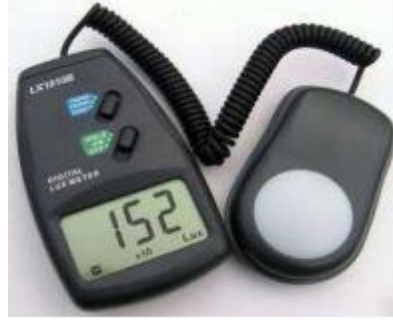
Resim 6.1. Lüksmetre veya ışıkölçer (İsmail vd., 201, s. 70)
