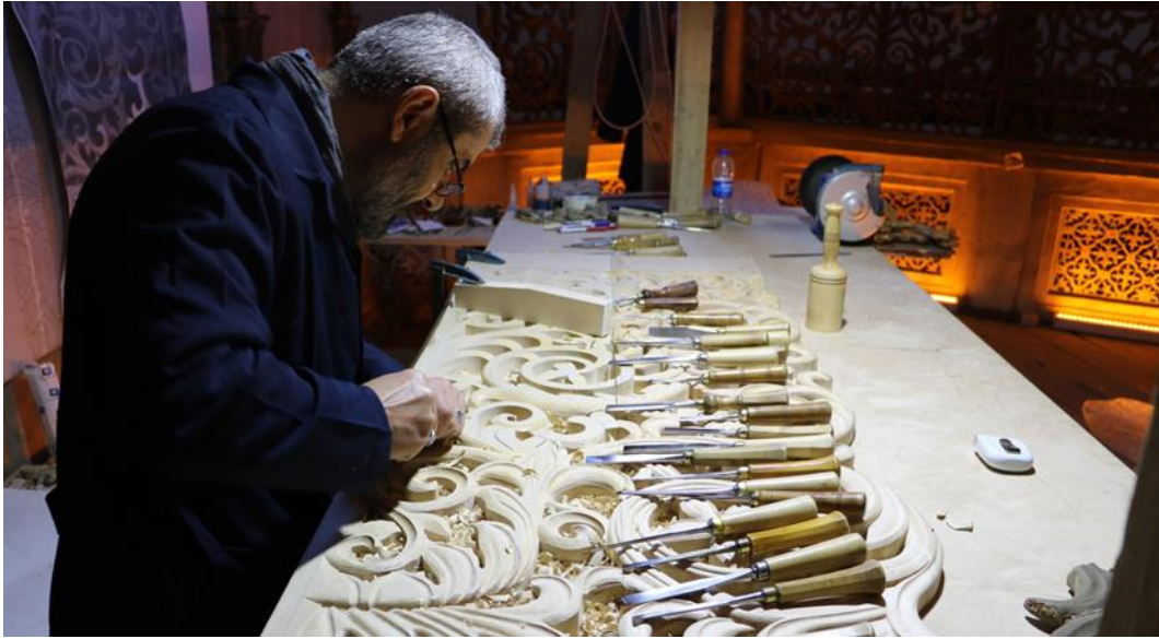
Resim 5.214. Oyma işlemi (oyma ustası Hüseyin SÜRÜN)
