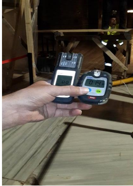
Resim 5.196. Ortam gaz kontrolü
