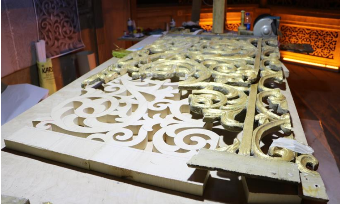
Resim 5.209. Kesim yapılan motifin kontrolü
