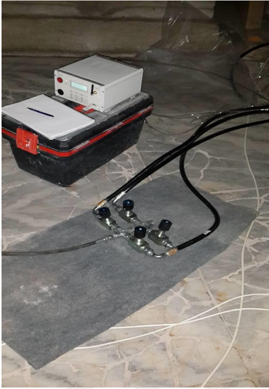
Resim 5.189. Fumigant iletim hattı
