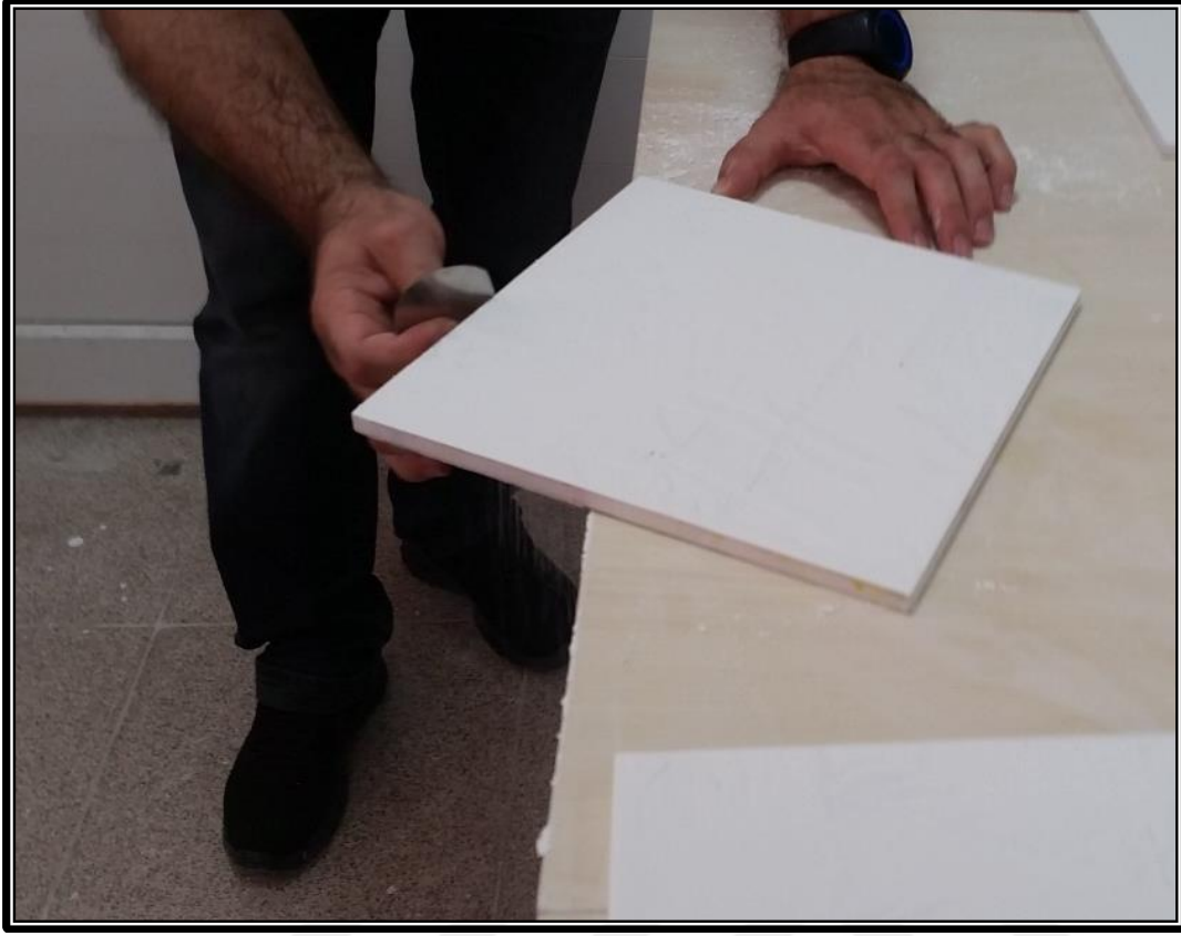
Resim 8.9. Sıraltı tekniđi uygulanan bisküvi karonun fırın öncesi kenarlarının temizlenmesi
