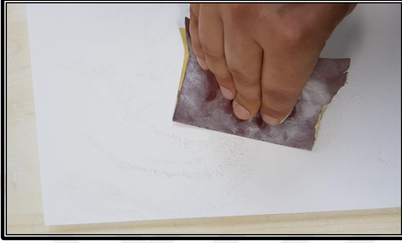
Resim 8.3. Çini karonun sıfır zımpara ile zımparalanmasından bir görünüm
