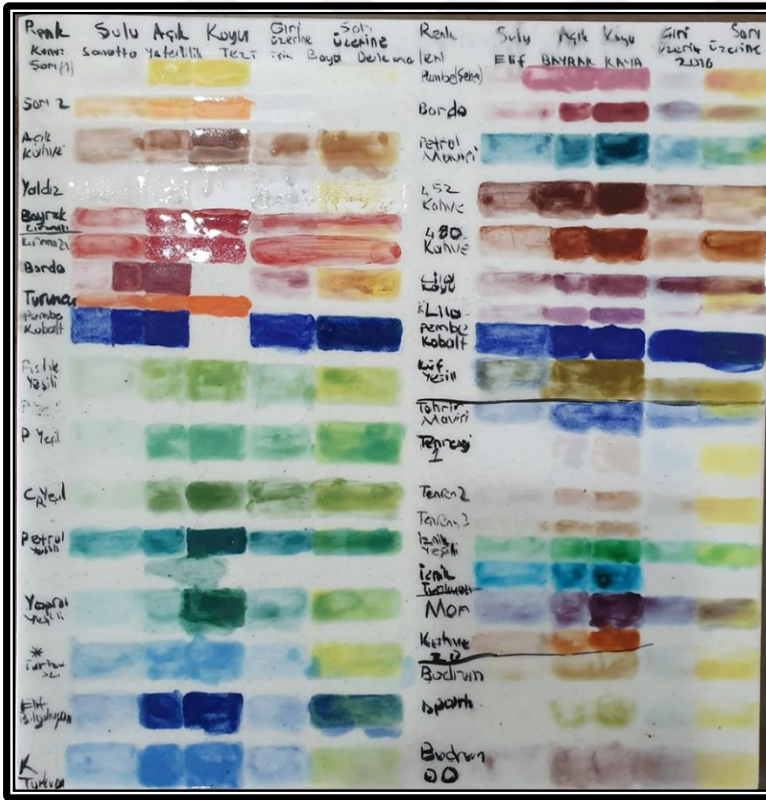
Resim 8.2. Çini boyaları ile elde edilen renk çeşitlerinin bisküvi karo plaka üzerine boyanarak fırınlanmış hali
