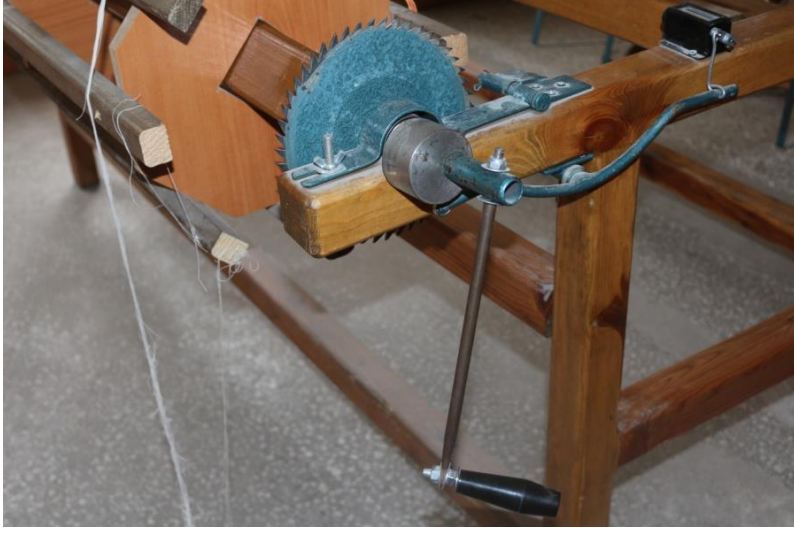
Resim 2.27. Bir ucu sayımatığe bağlı leventlere çözümlü ipliğini saran kol (Bakır, 2018)
