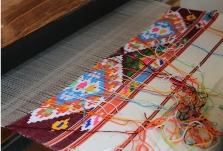
Resim 2.30. Dokumada oluşturulan desen ve desen iplikleri (Bakır, 2018)
