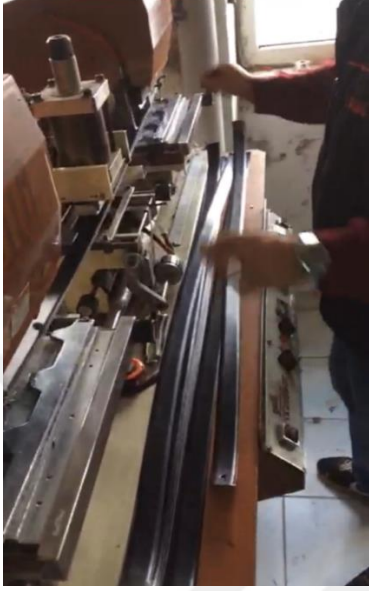
Resim 4.34. Boylama makinesinde kemerin kesimi, deliklerin açılması
