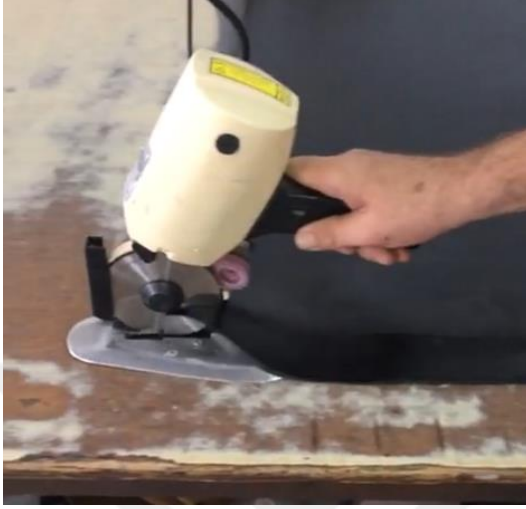
Resim 4.19. Yuvarlak uçlu deri kesim makinesi
