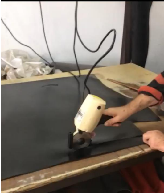
Resim 4.29. Derinin yuvarlak bıçaklı kesim motoru ile kesimi
