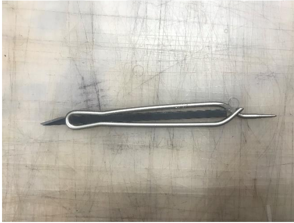
Resim 4.2. Derim kesim bıçağı (falçata)
