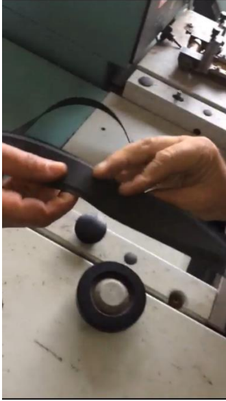
Resim 4.31. Deri şeritlerin yarma makinesinde tıraşlanması ve inceltilmesi
