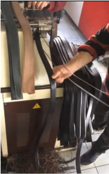
Resim 4.33. Mahat makinesinde şeritlerin kemer haline gelmesi ve kenar fazlalıkların alınması
