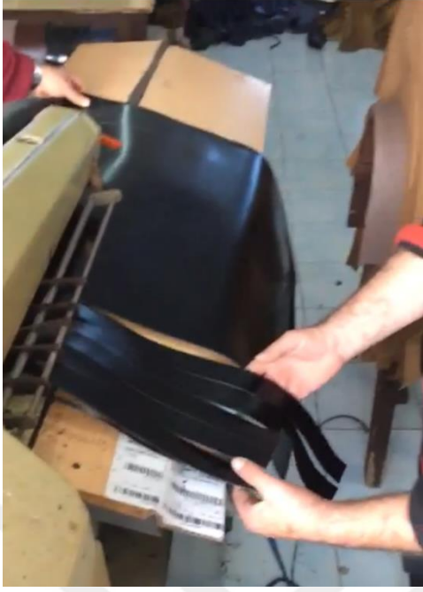
Resim 4.30. Derinin şerit kesim makinesinde kesilmesi
