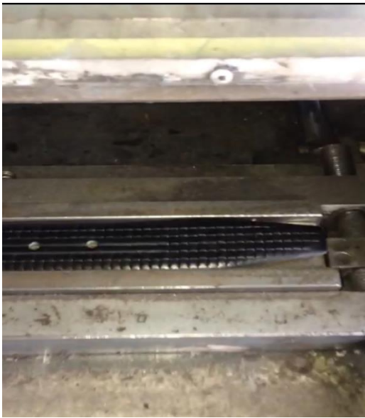
Resim 4.35. Baskı makinesinde deriye desen basma
