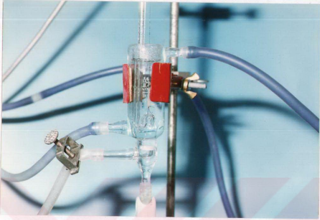
Resim 4: Sıçan proksimal kolon longitudinal kas şeridinin organ banyosu içinde görünümü
