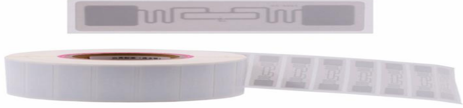
Şekil 3.4. Pasif Şekilde Araç Etiketi (RFID Tag)
