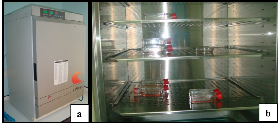
Resim 50: Hcre kltrnn yapıldıęı inkbatrn grnm a) Inkbatrn dıřarıdan grnm b) Hcrelerin flask iinde inkbatrdeki grnmleri
