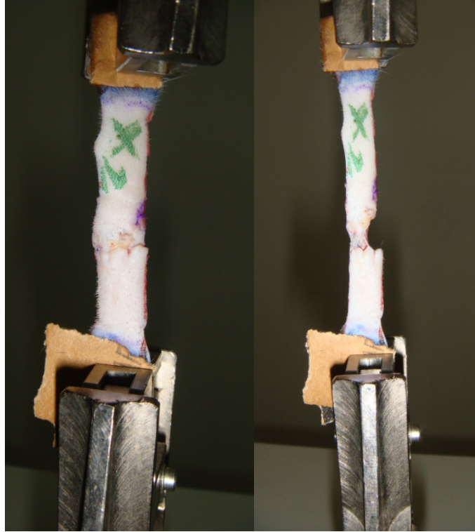
Resim 56: x2 parçasına uygulanan doku kopma kuvveti (breaking strength) testi
