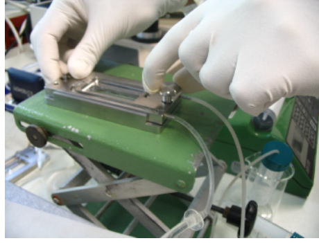
Şekil 6. Akım lamının, akım odasına yerleştirilmesi ve akım odasının kapatılması.
