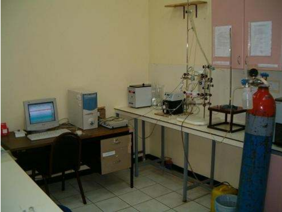
Şekil 8. Langendorff izole perfüze kalp sistemi ve Data Acquisition Sistem
