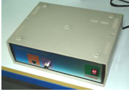
Şekil 15. Aygıtın motor sürücü donanımı
