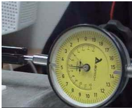
Şekil 17. Kalibrasyon için kullanılan komparatörlü düzenek
