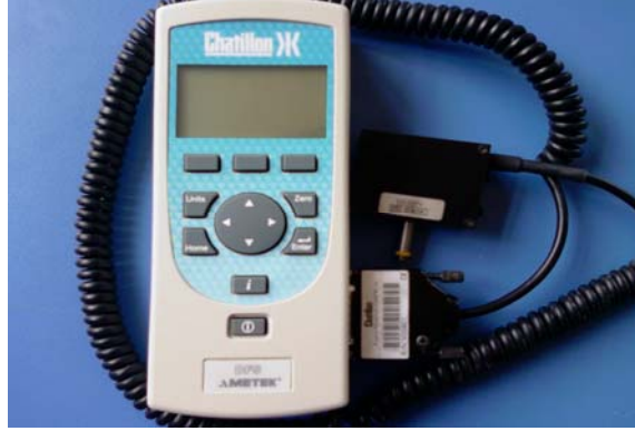
Şekil 13. Denede kullanılan yük hücresi ve dijital gösterge aygıtı
