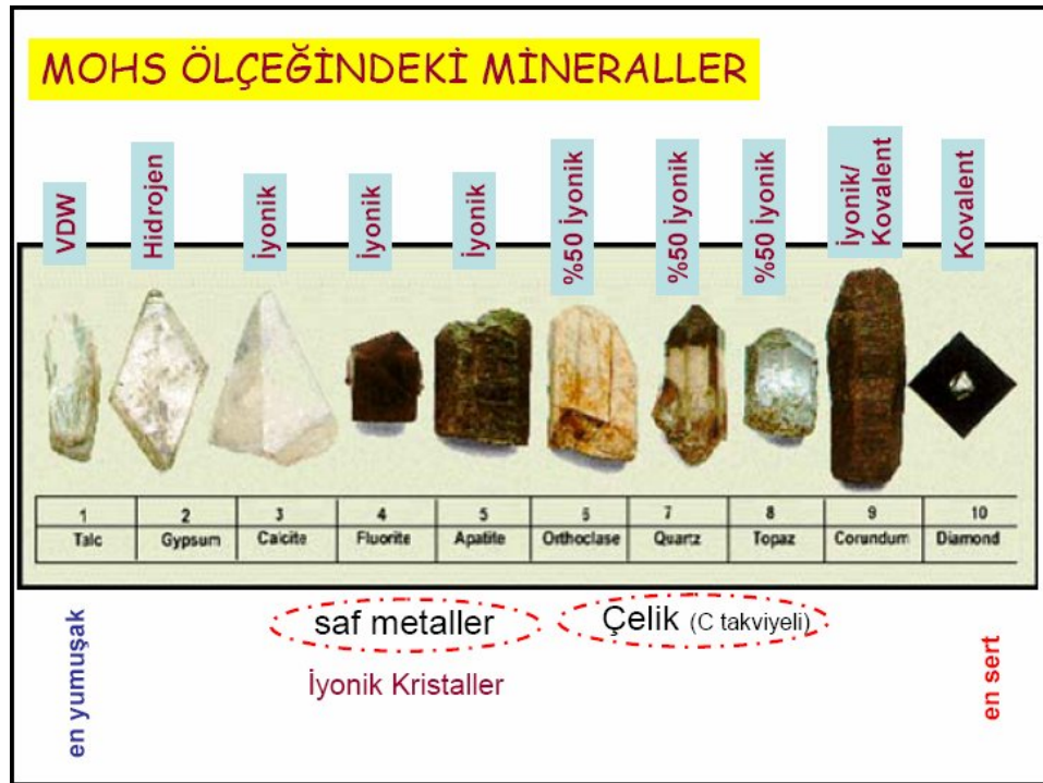
Şekil 1: Mohs ölçeğine göre malzemelerin sertlik sıralaması (Yrd. Doç. Dr. Metin ÖZGÜL, AKÜ Seramik Mühendisliği 2007 ders notları)
