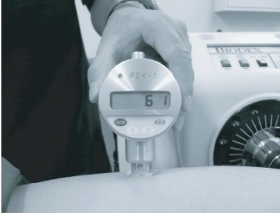
Şekil 20: Durometre ile doku sertlik ölçümü (Kinoshita ve arkadaşları, 2006)
