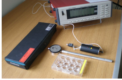
Şekil 33: Slikon yapı ölçümü için kurulan deney düzeneği
