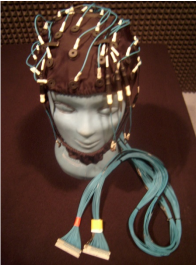
Şekil 8. Saçlı deriden kayıt almak için özel olarak tasarlanan 64 kanallı Quik kep
