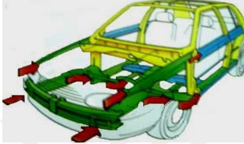
Şekil 1: Otomobilde şase parçalarında kuvvetin iletilme yönleri
