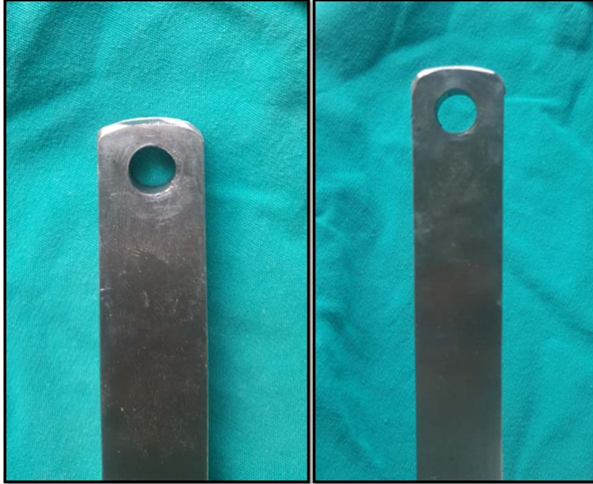
Şekil 22: Bastırıcı baş (yarıçap 24 mm)
