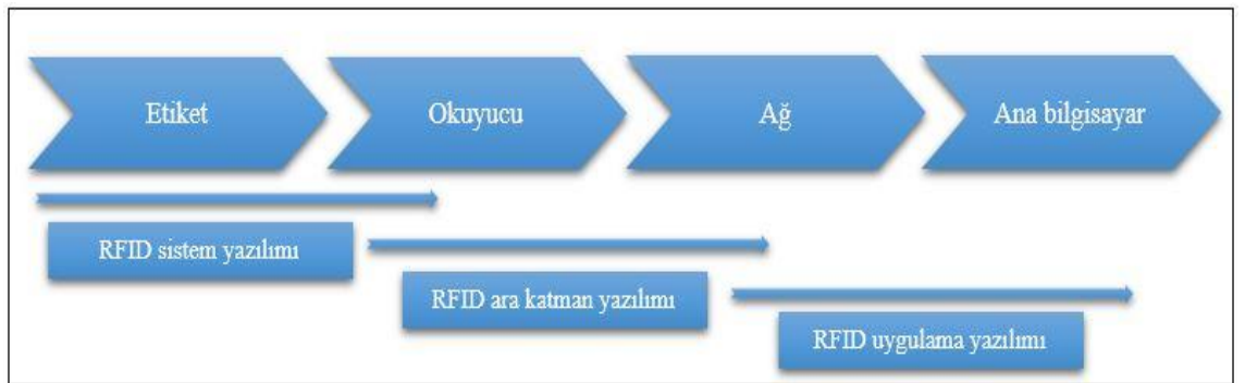
Şekil 1.8. RFID Sistem Yazılımı Akış Yönü
