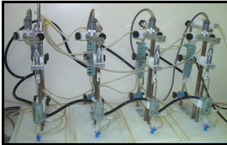
Resim 2. Dokuların izole organ banyosu sistemine asılması ve verilerin transducer aracılığı ile kaydı
