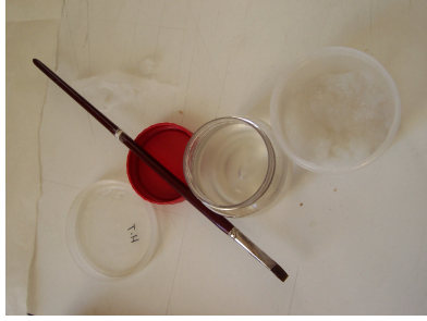
Resim 46: Yapıştırıcı olarak kullanılan CMC, Nişasta kolası ve fırça
