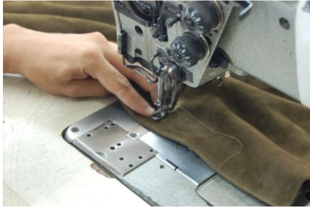
Resim 56:Deri parçaları dikilmeden önce çeşitli yapıştırıcılarla sabitlenmektedir.
