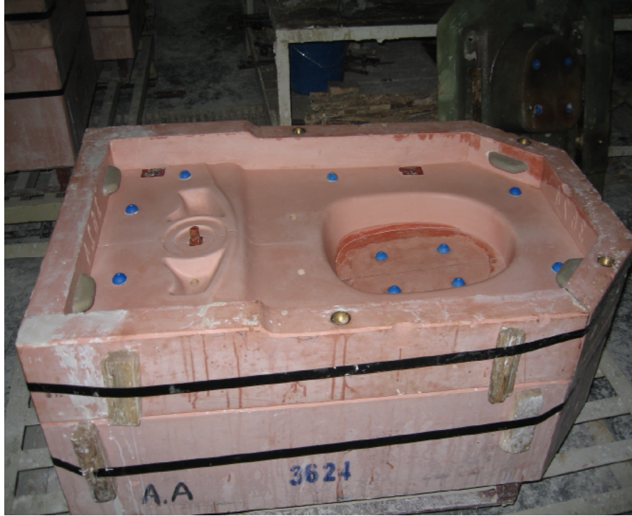
Fotoğraf 52: Üst kapak parçalı teksiri
