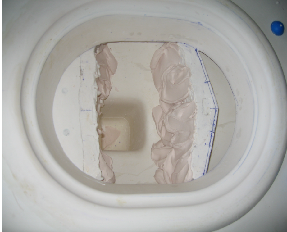
Fotoğraf 29: Hazne ii ekirdek paralarının yapımı.
