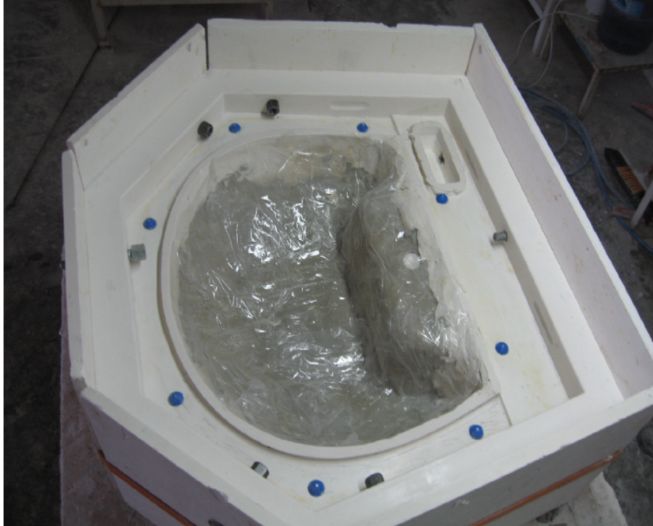
Fotoğraf 66: Silikonlu olacak yüzeye çamur döşenmesi
