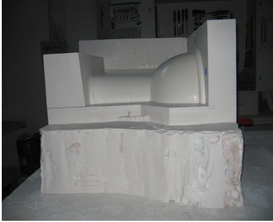
Fotoğraf 19: Kalıp bandının oluşturulması
