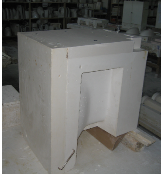
Fotoğraf 27: Kalıp arka parçasının oluşmuş hali
