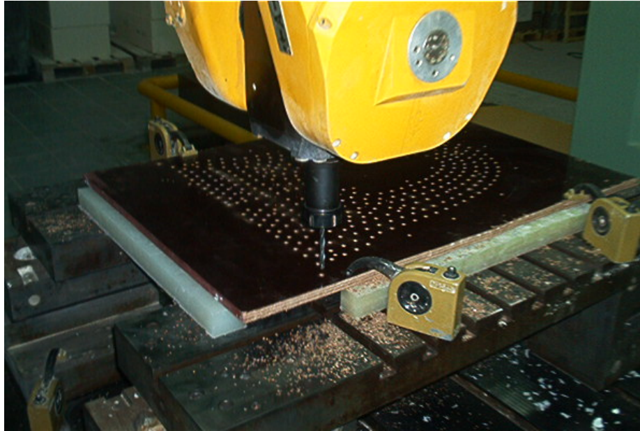
Fotoğraf 90: PMMA malzemesini dökmeden önce şifrenin yerleştirileceği plakanın CNC'de işlenmesi
