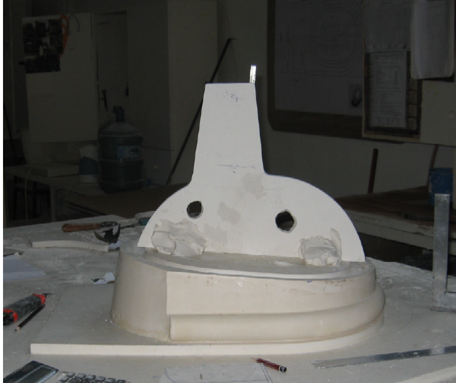
Fotoğraf 5: Klozetin ring ve hazne içinin şekillendirilmesi
