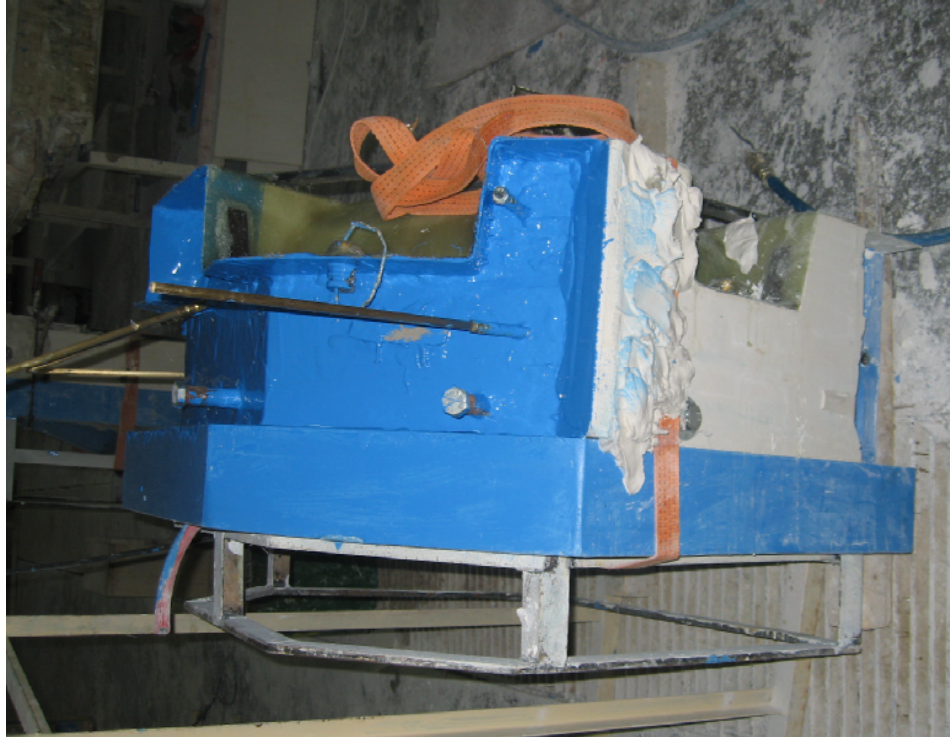
Fotoğraf 69: Havalı sistem yan ceketlerin oluřturulması
