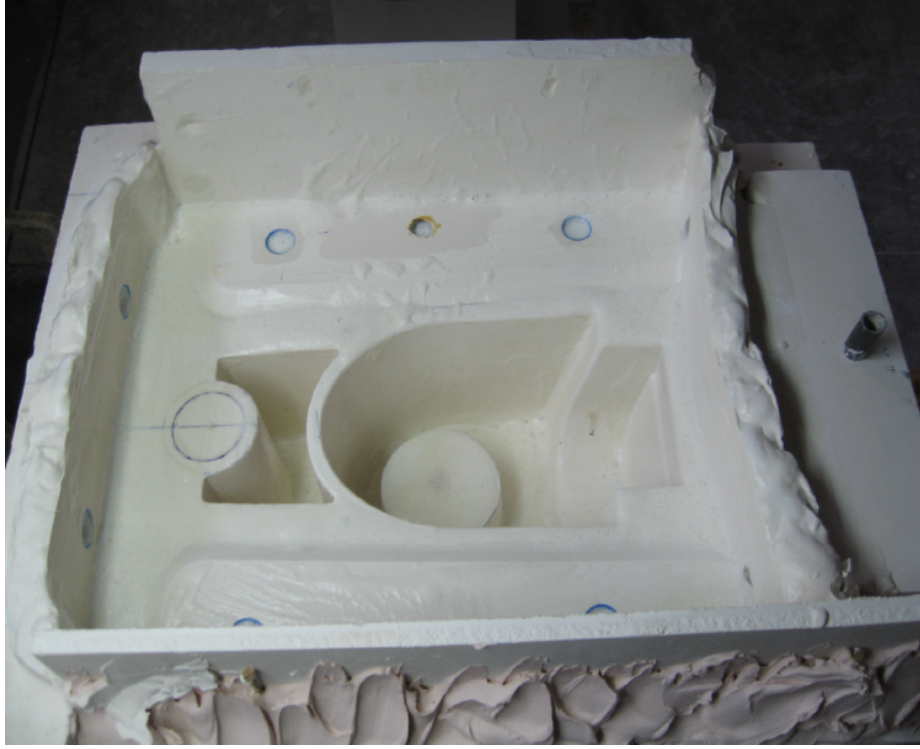
Fotoğraf 24: Kalıp arka parçasının döküm hazırlığı
