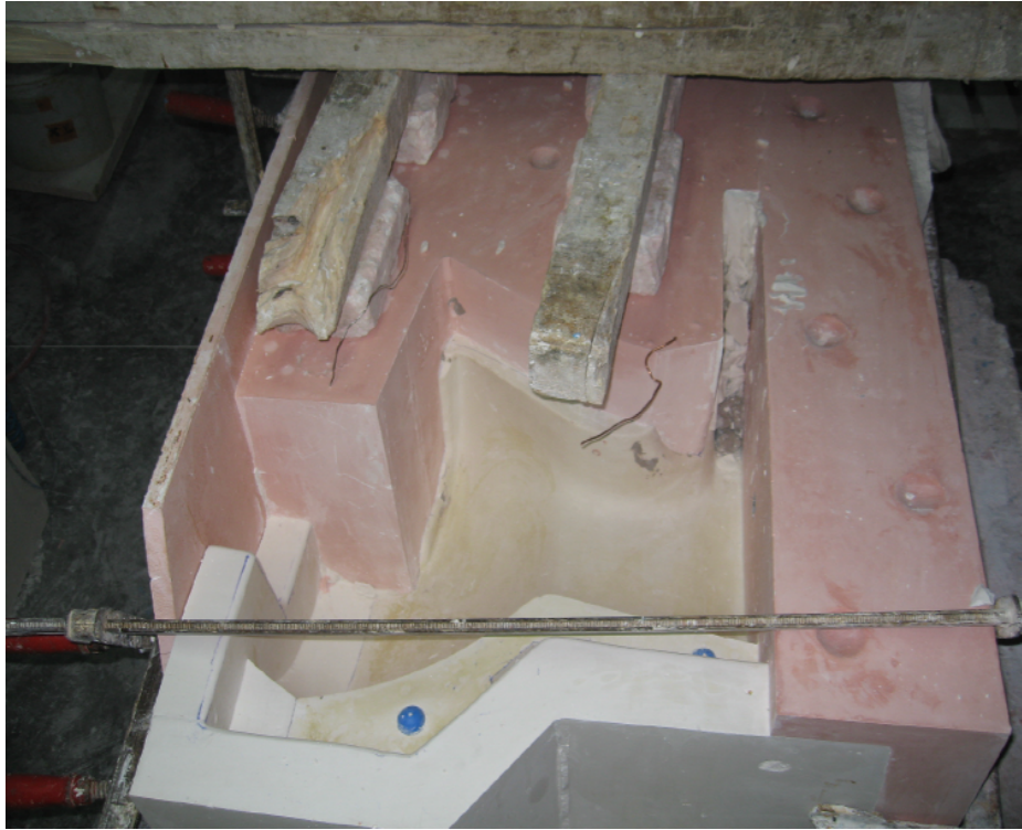
Fotoğraf 44: Parçalı alçı teksirin oluşumu
