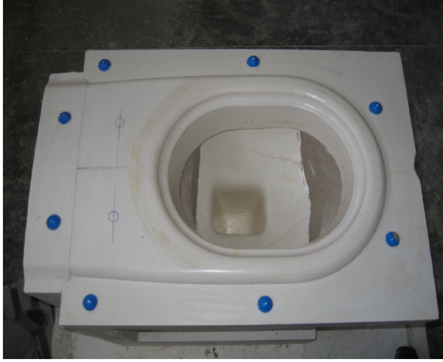
Fotoğraf 28: Hazne ii ekirdek paralarının yapımı.
