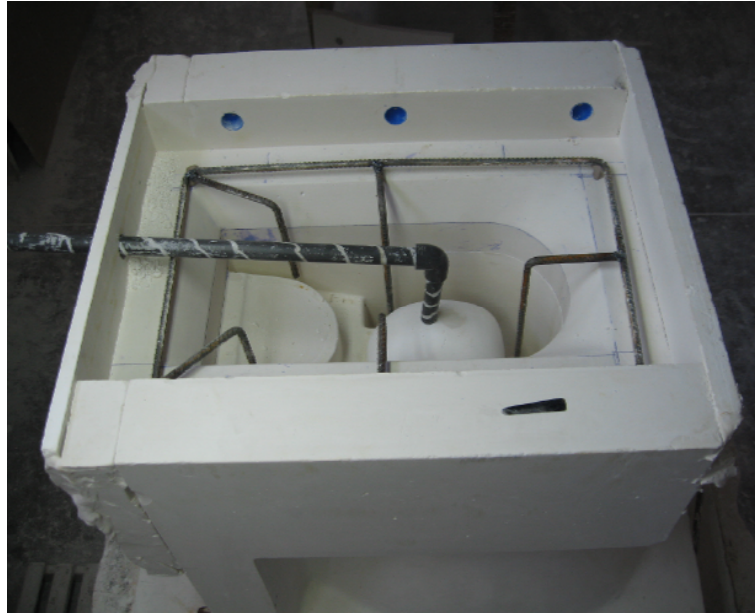
Fotoğraf 23: Kalıp dip parçasına konan yardımcı malzemeler
