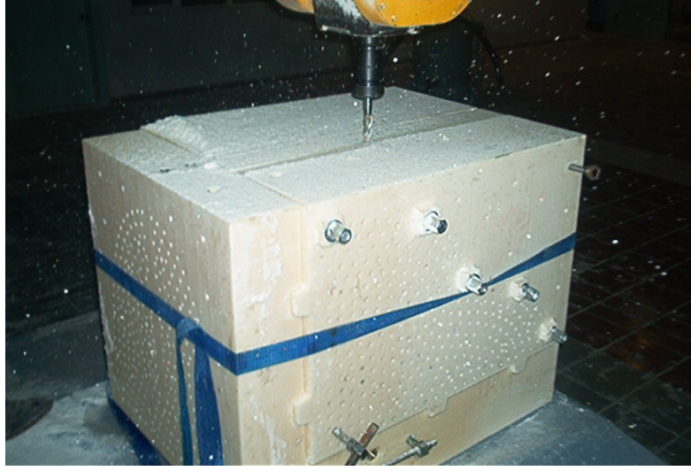
Fotoğraf 94: Dökülen kalıp parçasının birleştirilerek CNC’de traşlanması
