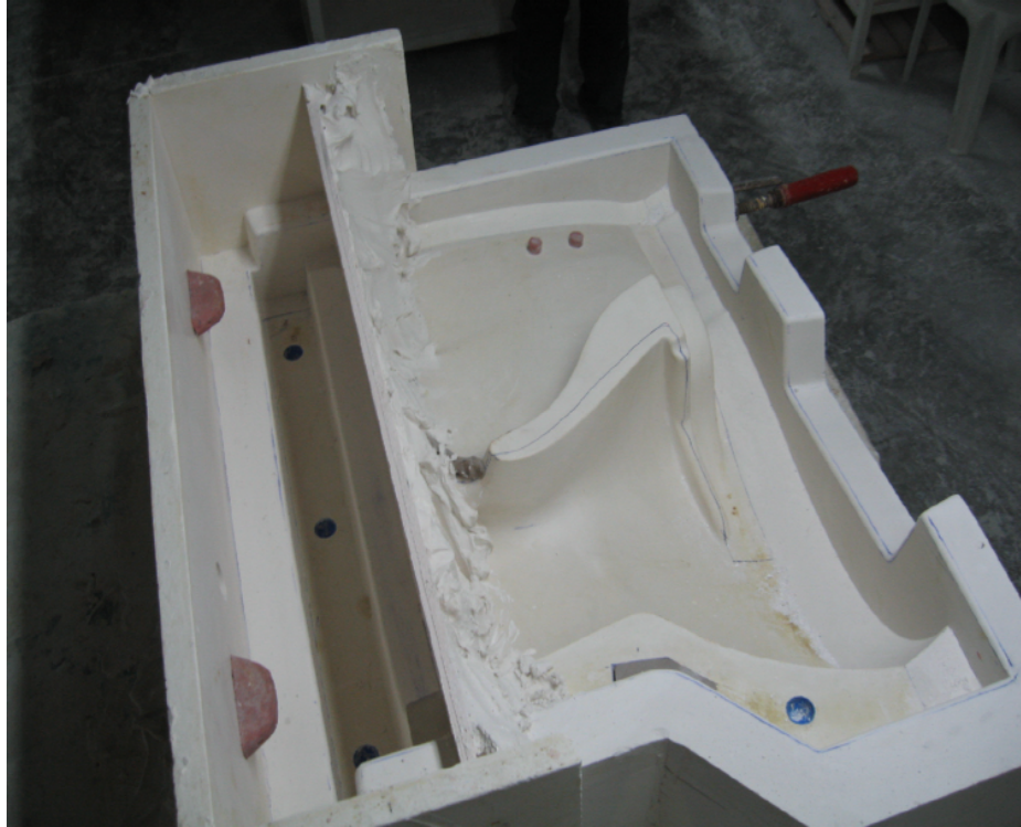
Fotoğraf 36: Paralı alçı teksire başlama
