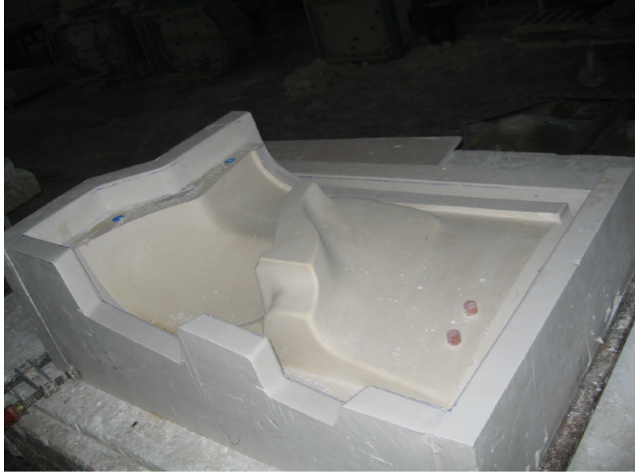
Fotoğraf 35: Alçı teksir yan kalıp enayi ceketlerin alışılması
