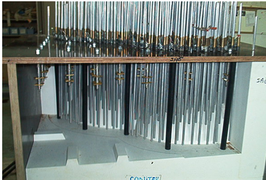
Fotoğraf 92: Teksiri döküme hazır hale getirme işlemi
