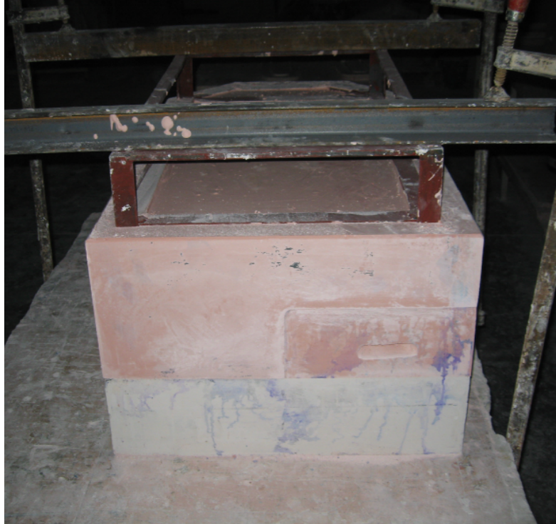
Fotoğraf 38: Alt toplama parçanın dökümü
