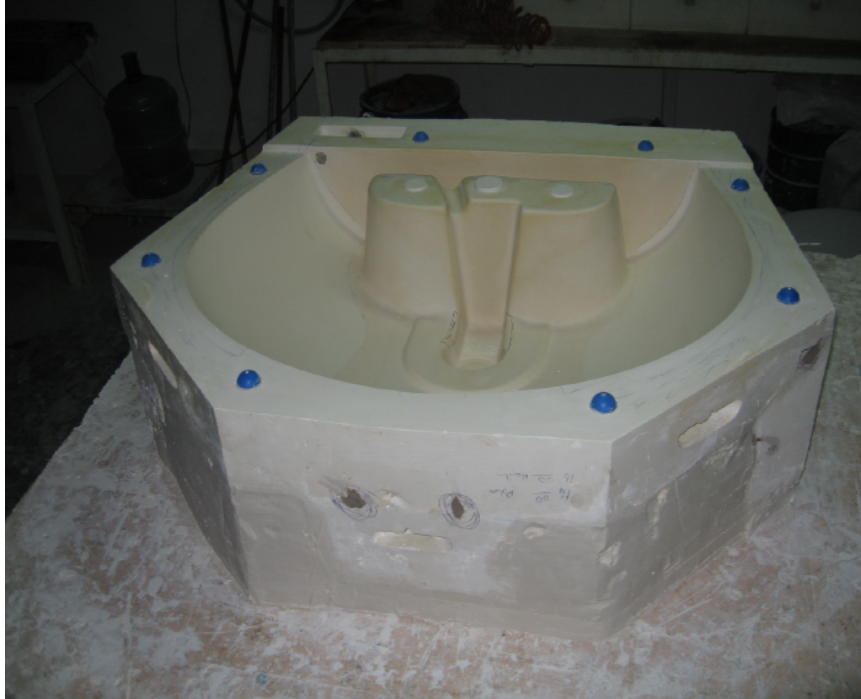
Fotoğraf 62: Silikon-Aralditli teksir yapım aşamaları
