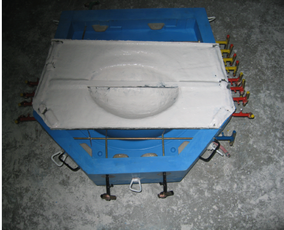
Fotoğraf 84: Lavabo erkek parçası araldit havalı teksiri
