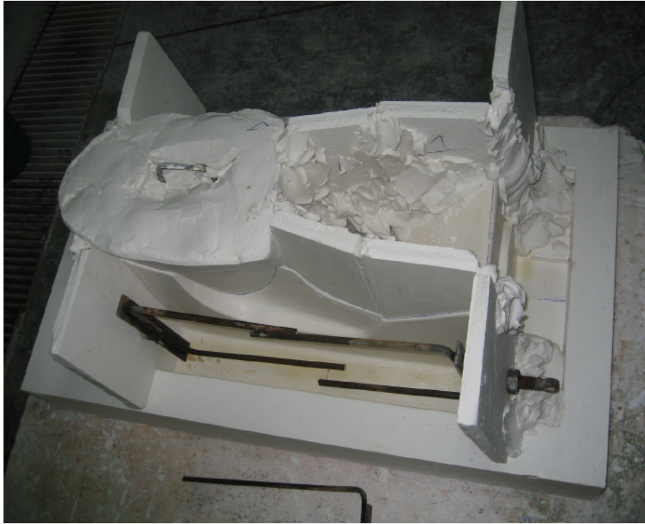
Fotoğraf 54: Dip parça teksirini bölme işlemi
