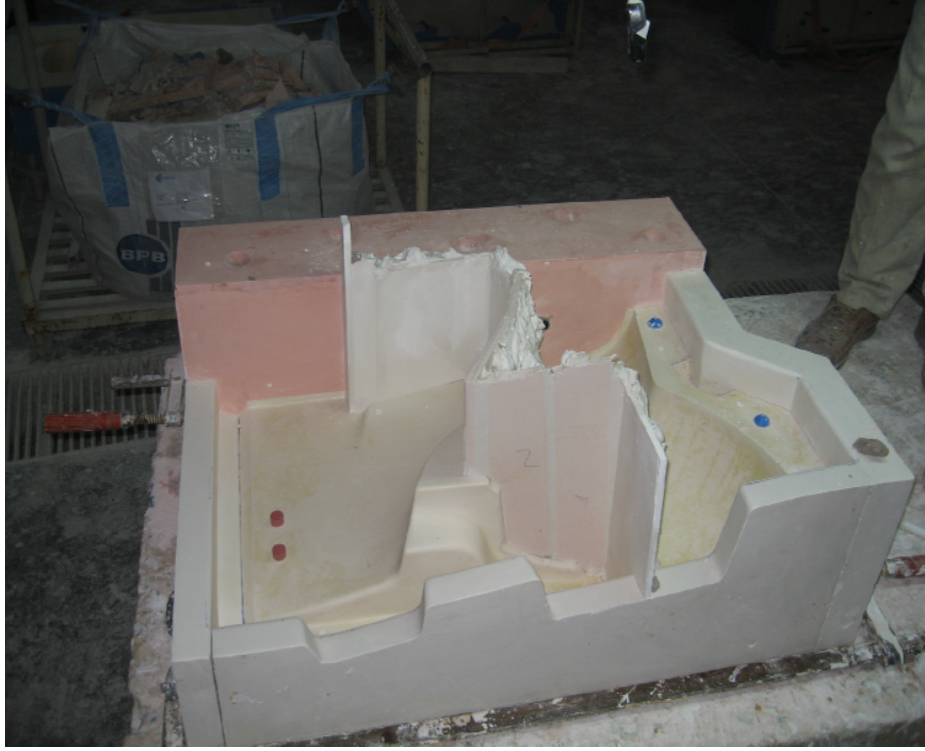
Fotoğraf 43: Parçalı alçı teksirin oluşumu
