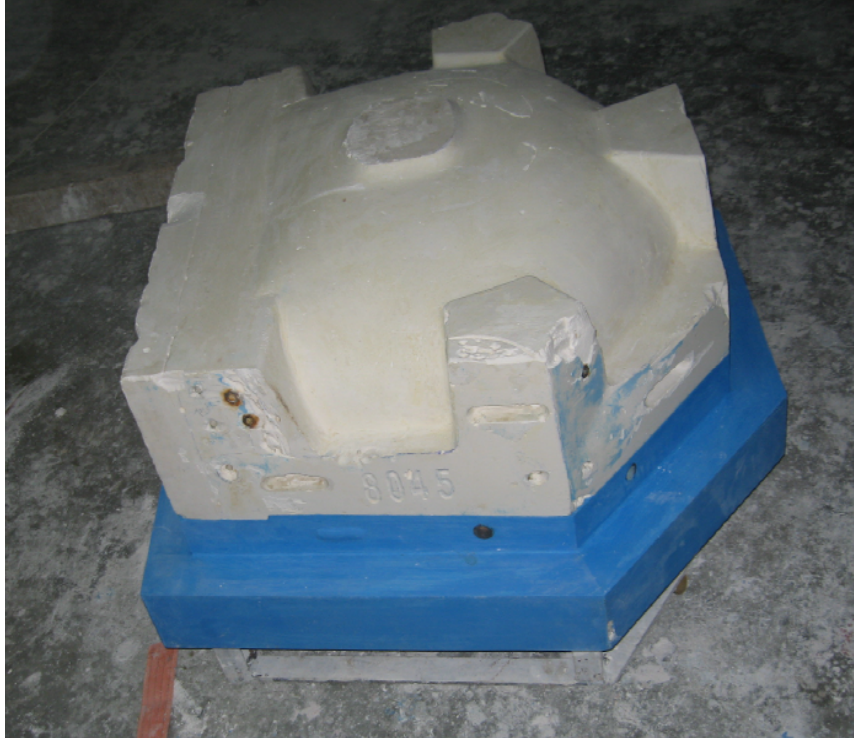
Fotoğraf 71: Silikon dökmeye hazırlık
