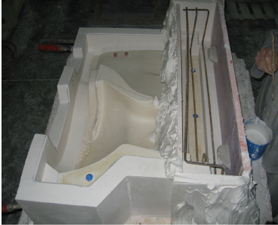
Fotoğraf 42: Parçalı alçı teksire başlama
