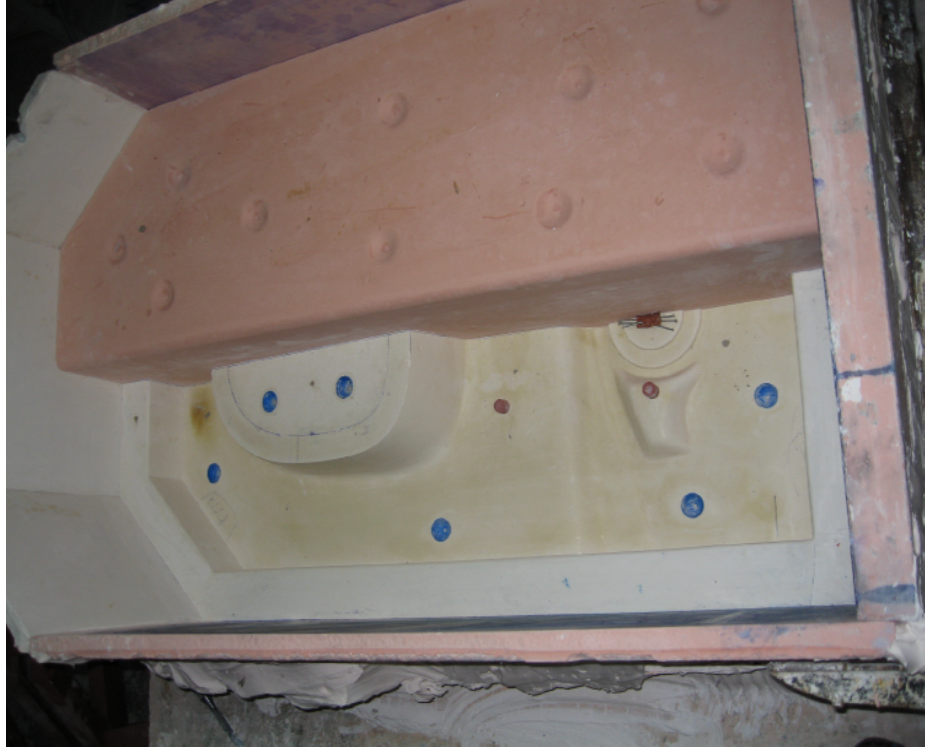
Fotoğraf 49: Üst kapak teksirinin oluşturulması
