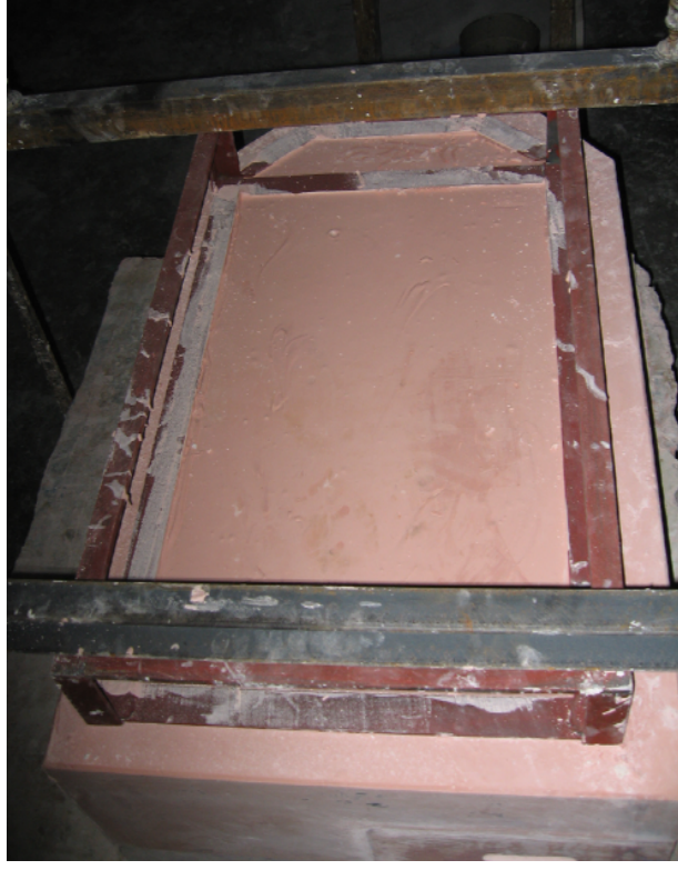
Fotoğraf 45: Parçalı alçı teksir alt toplama parçası
