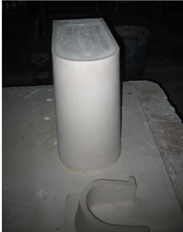
Fotoğraf 9: Klozetin ayak (taban) bölgesinin şekillendirilmesi
