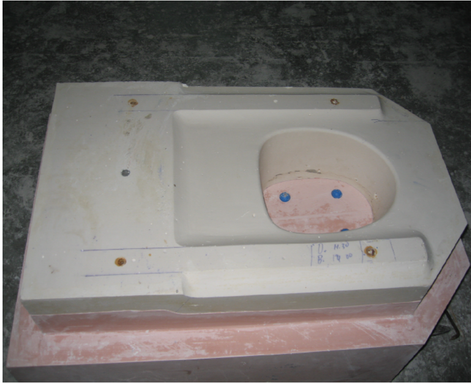
Fotoğraf 50: Üst kapak polyester yapımına hazırlık
