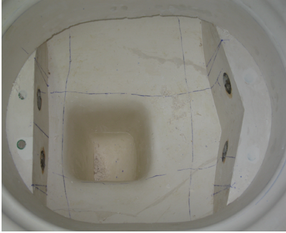
Fotoğraf 30: Hazne ii ekirdek paralarının yapımı.
