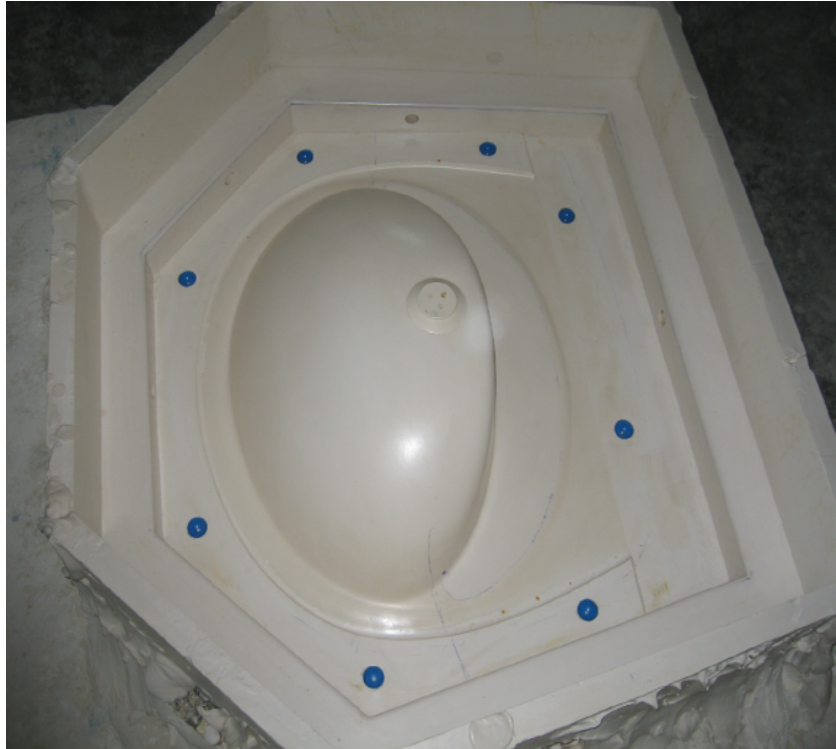
Fotoğraf 78: Teksir gövdesinin oluşumu için plakaların yerleştirilmesi
