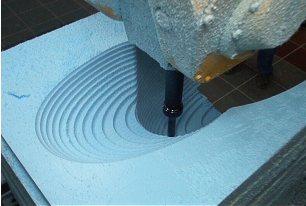
Fotoğraf 88: CNC’de basınçlı döküm kalıbının alçıdan işlenmesi
