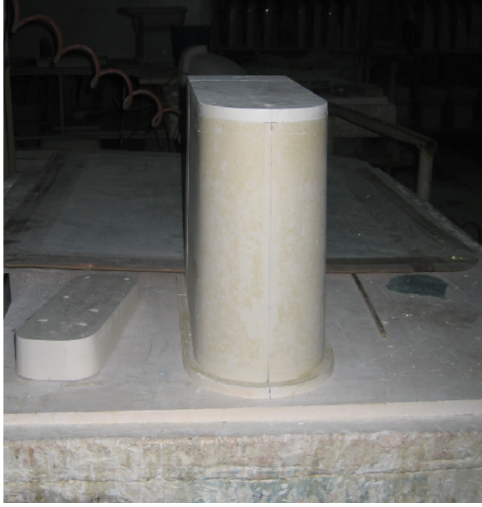
Fotoğraf 8: Klozetin ayak (taban) bölgesinin şekillendirilmesi
