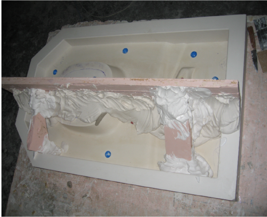
Fotoğraf 48: Üst kapak teksiri bölme işlemi
