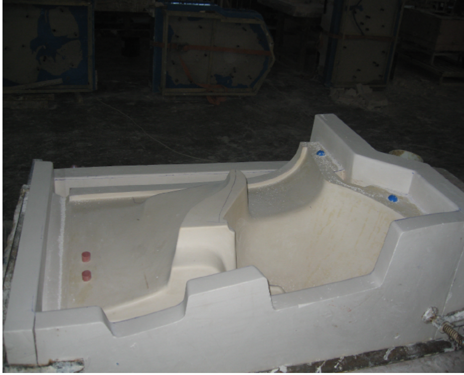
Fotoğraf 41: Alçı teksir sađ yan parça enayi ceketleri
