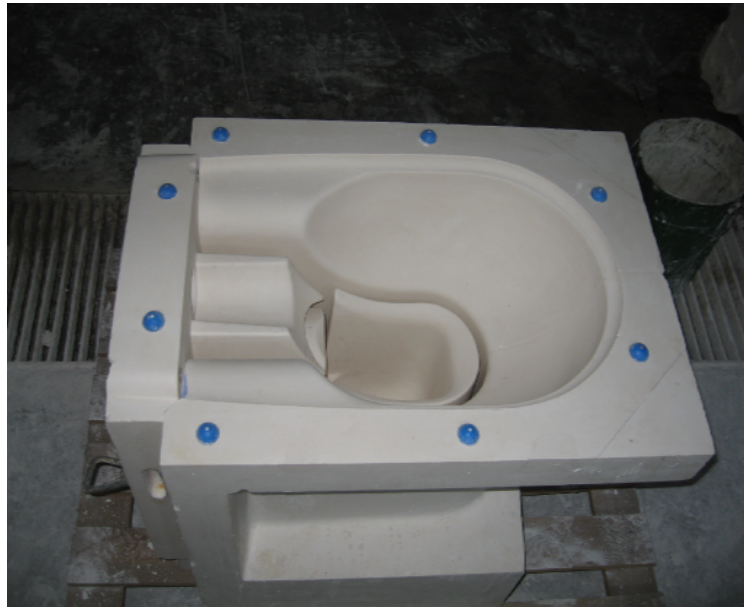
Fotoğraf 33: Model kalıbın rötuşlandıktan sonra açık haldeki görünüşü
