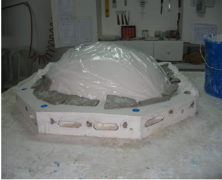
Fotoğraf 75: Lavabo erkek teksir yapımına başlama
