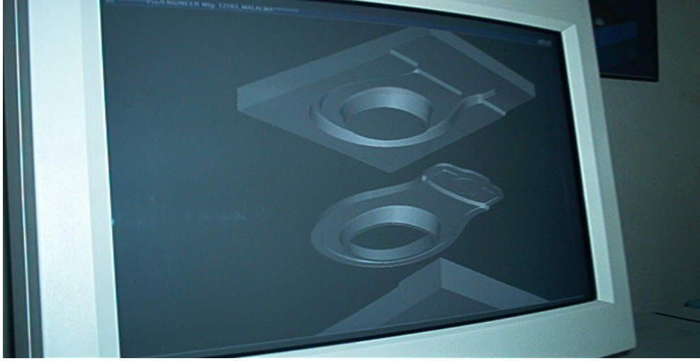
Fotoğraf 85: Bilgisayar ortamında basınçlı kalıbın model tasarımı
