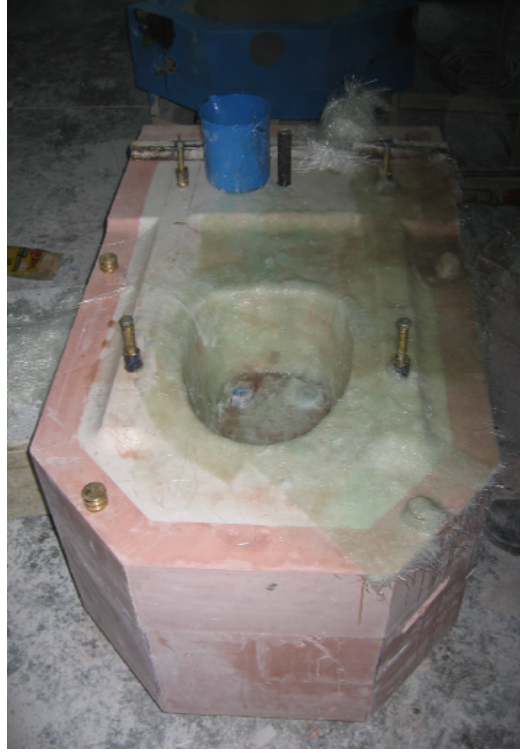
Fotoğraf 51: Polyester üst kapak yapımı
