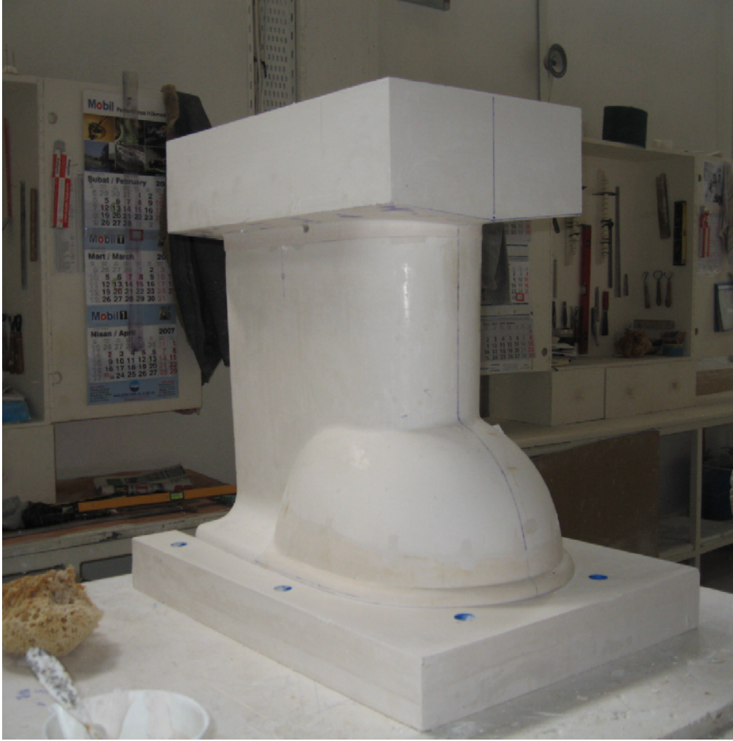
Fotoğraf 17: Model kalıp üst ve alt parçaların yardımcı parçaları
