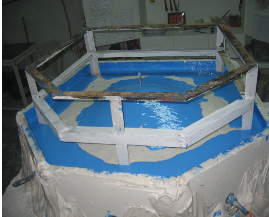
Fotoğraf 80: Dolgu malzemesi ile doldurulan teksirin köşebent demirleri ile desteklenmesi
