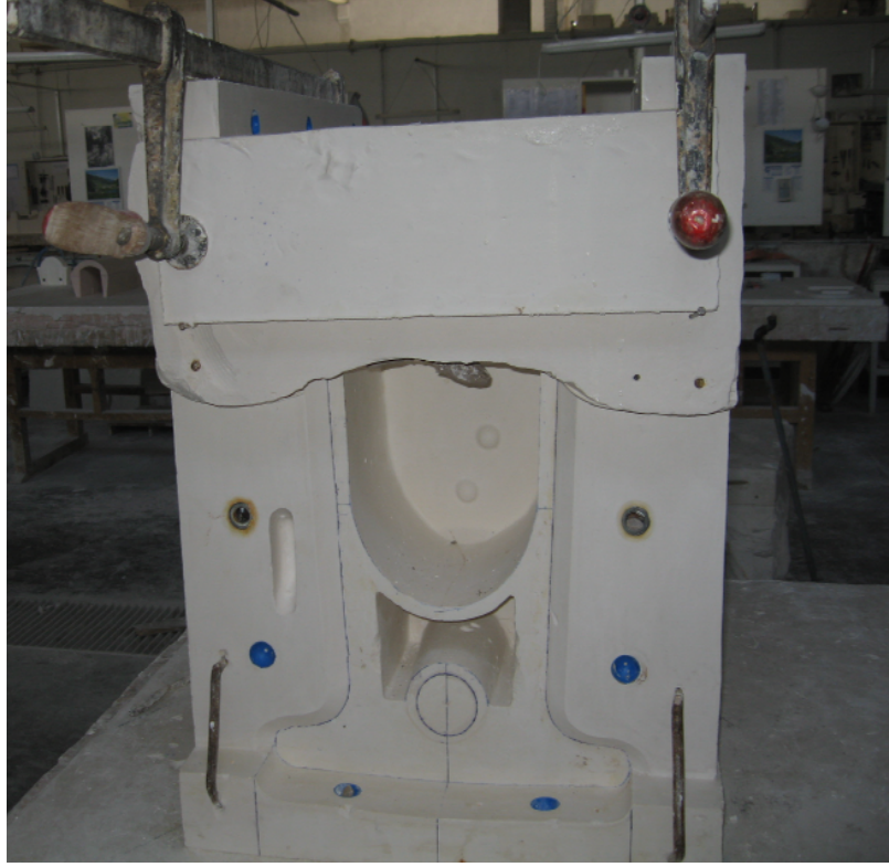
Fotoğraf 22: Kalıp dip parçasının oluşturulması
