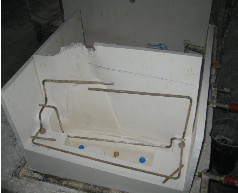
Fotoğraf 58: Arka parça teksirin yapımı
