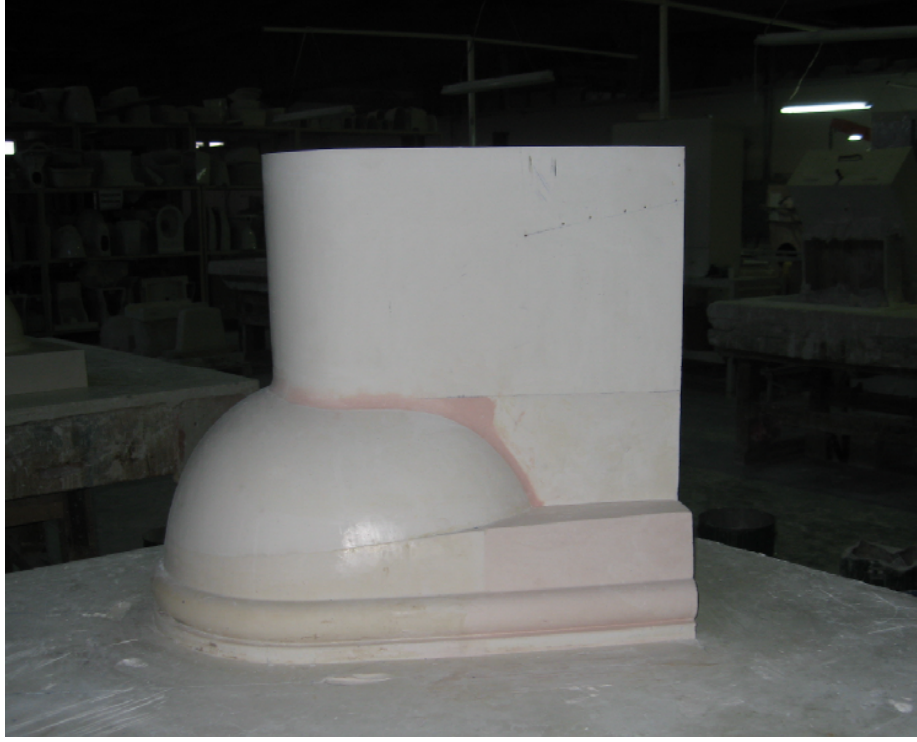
Fotoğraf 12: Şablonla şekillendirilen ön model
