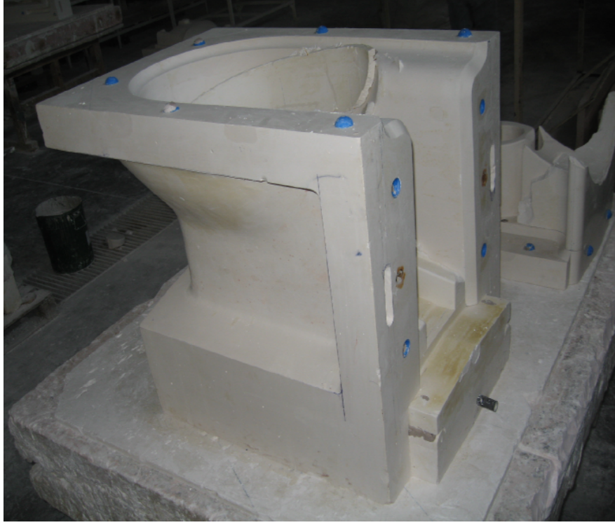
Fotoğraf 32: Oluşturulan model kalıbın açılması
