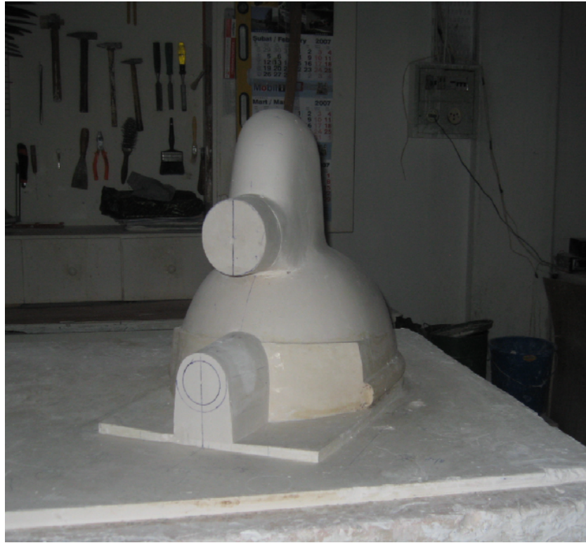
Fotoğraf 7: Klozetin hazne sifon ve su giriřinin řekillendirilmesi
