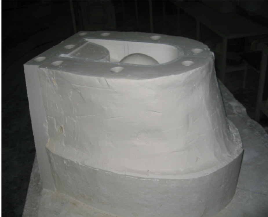
Fotoğraf 13: Ön model kalıbı
