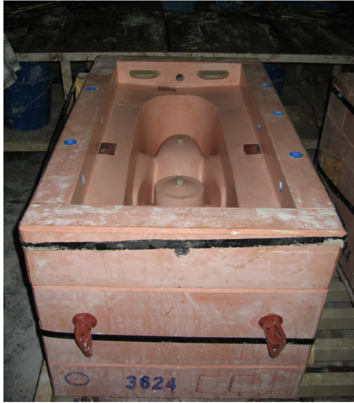
Fotoğraf 56: Dip parça teksiri
