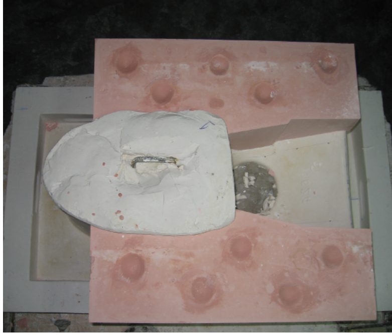
Fotoğraf 55: Dip parça teksirin blokları
