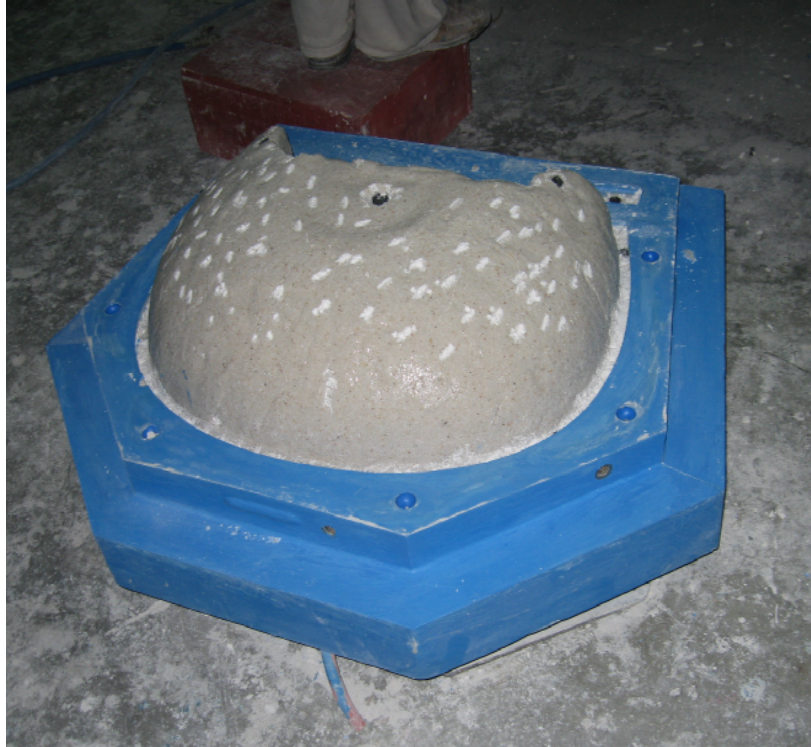
Fotoğraf 70: Silikon dökülecek yüzeyin hazırlanması
