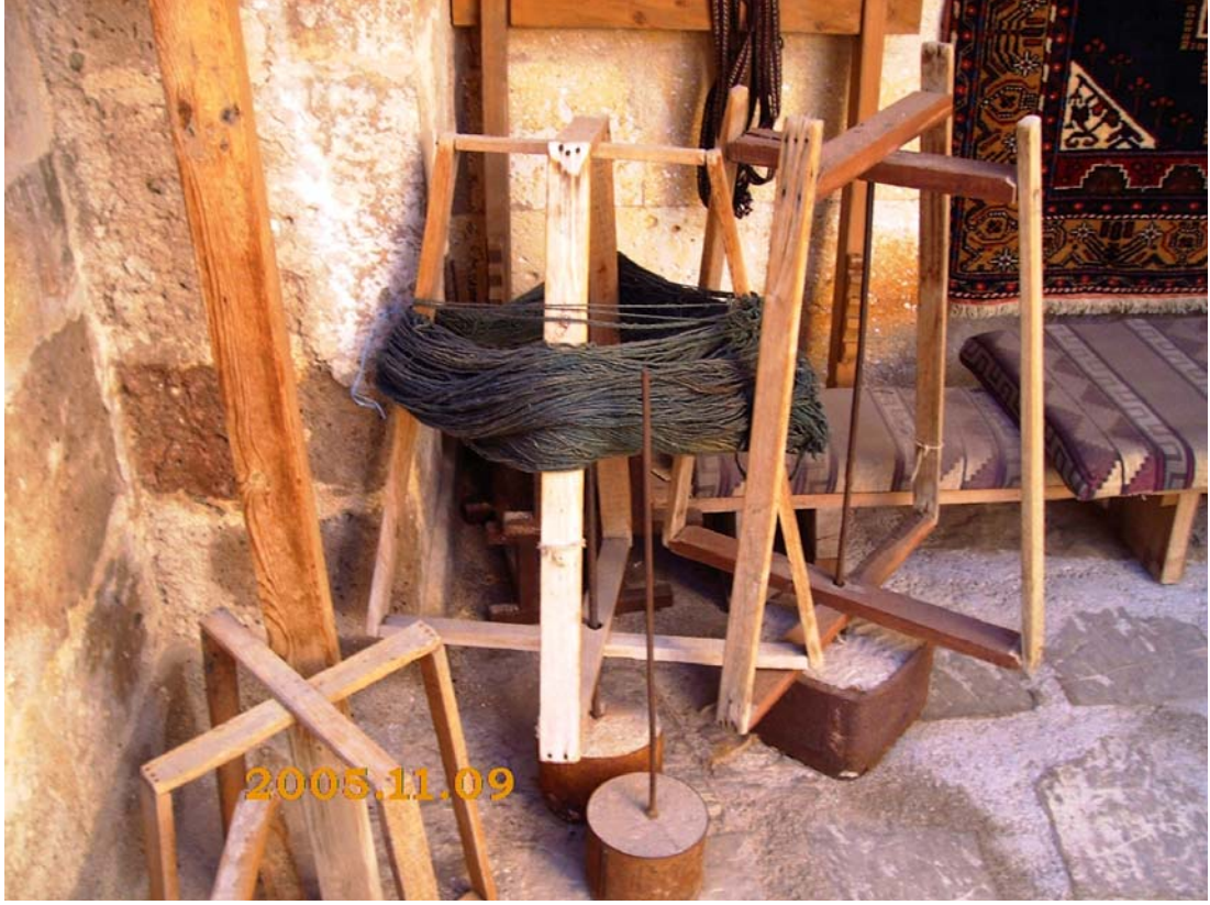
Foto 10: Çile halindeki yünleri yumak haline getirmekte kullanılan gülçenler.
