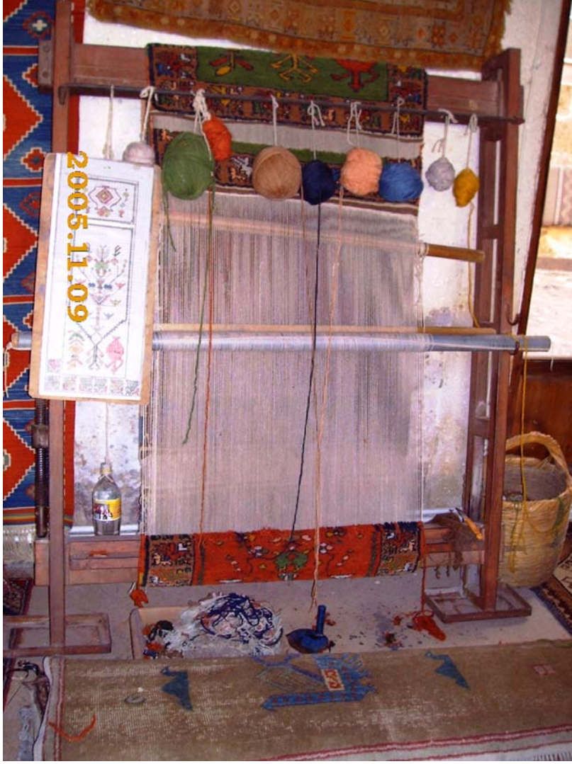
Foto 8: Gösteri amaçlı dokumanın yapıldığı metal germe tip halı tezgahı ve Kırşehir seccade halısı.
