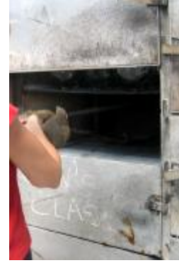
Resim 94: Camın tavlama fırınına konması
